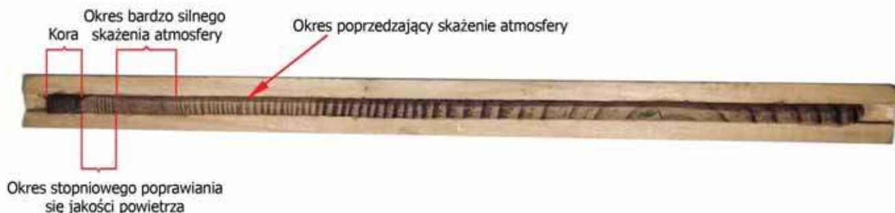
Ryc. 2. Próba dendrochronologiczna wraz z interpretacją redukcji przyrostów
