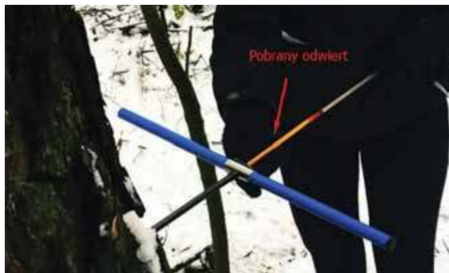
Ryc. 1. Pobór próby dendrochronologicznej za pomocą świdra Presslera
