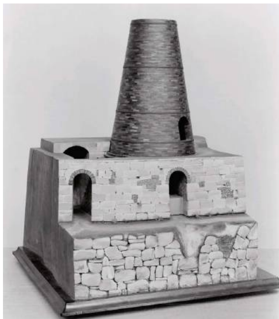
Model pieca użytego przez Josepha Aspdina do produkcji cementu portlandzkiego
