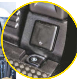
Gniazdo elektryczne 230 V stanowi wyposażenie standardowe. Poniżej – dodatkowy zaczep.
