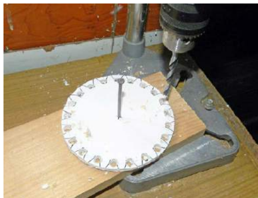
7. Wiercenie ułatwi wiertarka na kolumnie
