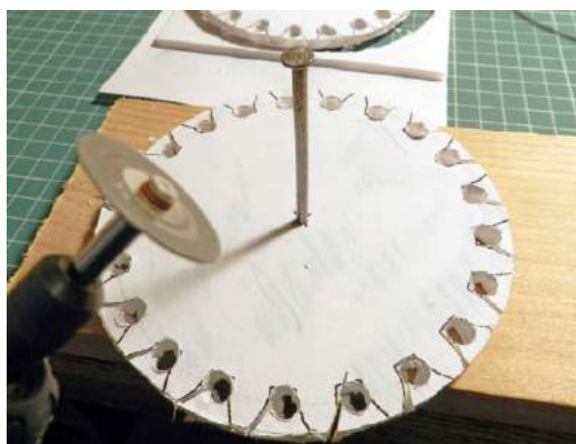
8. Tarcza do cięcia zamontowana na dremelu
