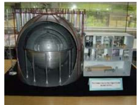
Fot. 2. Model detektora Borexino. Kolejne warstwy detektora coraz lepiej chronią wnętrze przed promieniowaniem. Borexino Collaboration
