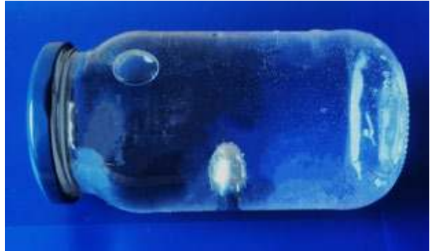
Fot. 1. Przykład wykonania przyrządu z pęcherzykiem powietrza do pokazu pływania w układzie poruszającym się ruchem przyspieszonym. (fot. autor)
