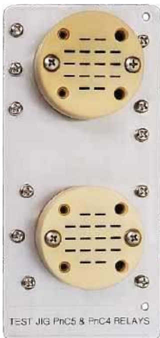
Zdjęcie 10 (po lewej): Wykonałem przyrząd do testowania i regulowania przełączników, używając dwóch podstawek pasujących do przełącznika PnC5
