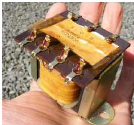
Rysunek 18b. Zdjęcie transformatora. Autor napisał: mam taki transformator (i tranzystory), które zastosuję we wzmacniaczu wykonanym wg schematu z rysunku 18a. Motywacja jest tu raczej dydaktyczna, jest nią również zaimitowanie do konstrukcji historycznych. Niemniej – o dziwo – wzmacniacz ten „brzmi” całkiem nieźle
