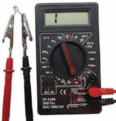
Fotografia 7. Sprawdzenie diody LED za pomocą multimetru ustawionego na testowanie diod. Po przyłożeniu sondy czerwonej do anody, a czarnej do katody, sprawna dioda LED powinna się zaświecić. Jeśli dioda ma odpowiednio długie (jeszcze nie przycięte) wyprowadzenia można się wspomóc krokodylkami
