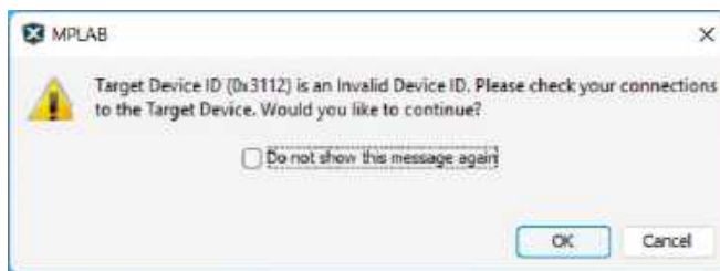
Ekran 1. Jeśli w trakcie programowania pojawi się komunikat o błędzie informujący, że 0x3112 to nieprawidłowy identyfikator układu PIC16F18146, można go bezpiecznie zignorować. Dokumentacja techniczna potwierdza, że 0x3112 to prawidłowy kod identyfikacyjny tego mikrokontrolera
