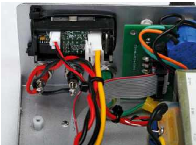
Widok z bliska na elementy i okablowanie za panelem przednim. Zwróć uwagę na izolację wyłącznika sieciowego
