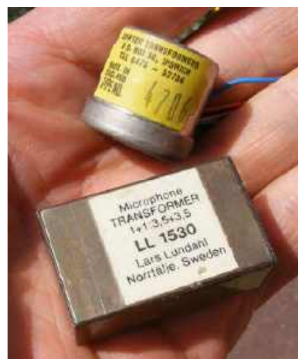
Rysunek 21. Zdjęcie pokazujące zewnętrzny wygląd dwóch transformatorów mikrofonowych; to jedno z najlepszych „produktów” w tym zakresie
