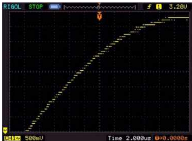
„Schodkowe” przybliżenie przebiegu w generatorze funkcyjnym pracującym z rozdzielczością 10 bitów (© 2019 Jos Verstraten)
