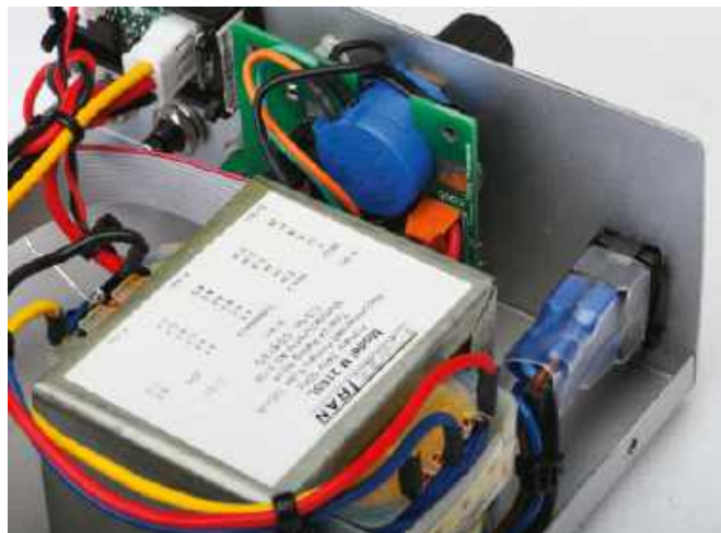
Widok z bliska na elementy i okablowanie za panelem przednim. Zwróć uwagę na izolację wyłącznika sieciowego
