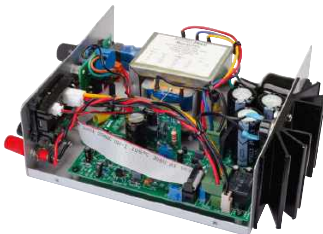
Po zakończeniu montażu wszystkich elementów i okablowania zasilacz powinien wyglądać jak na ilustracji powyżej. Po sprawdzeniu poprawności działania pozostaje tylko przymocować pokrywę za pomocą czterech dołączonych śrub - po dwie z każdej strony
