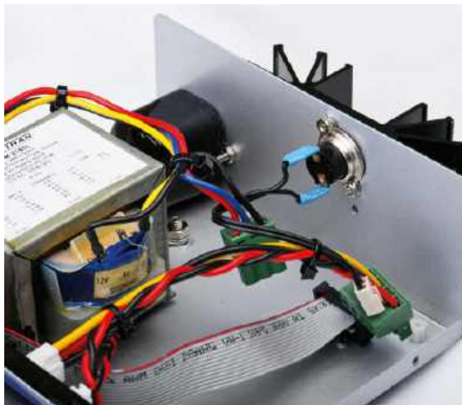
Widok z bliska na przełącznik termiczny po podłączeniu i zaizolowaniu
