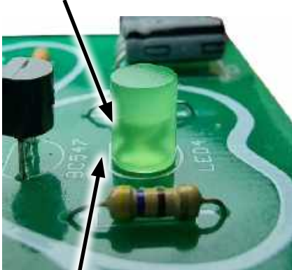
Prosty odcinek w obrysie diody LED na płytce wskazuje miejsce montażu katody diody LED
