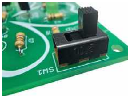
Fotografia 11. Poprawnie zamontowane włącznika zasilania SW1
