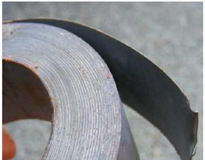
Rysunek 11. Rdzeń toroidalnego transformatora zwijany z długiej taśmy żelazowej w kształt toroidu
