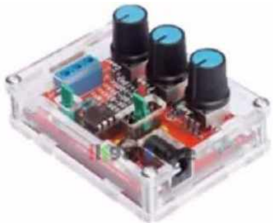
Dwa bardzo tanie analogowe generatory funkcyjne oferowane jako zestawy do samodzielnego montażu (© 2019 Jos Verstraten)
