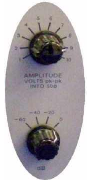
Praktyczna regulacja zakresu napięcia wyjściowego (© 2019 Jos Verstraten)
