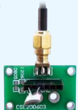
Opcjonalna płytka adaptera ułatwia testowanie komponentów
