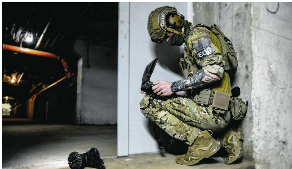
• PIAP trm to taktyczny robot miotany, używany do zwiadu i inspekcji FOT. MATERIAŁY PRASOWE
