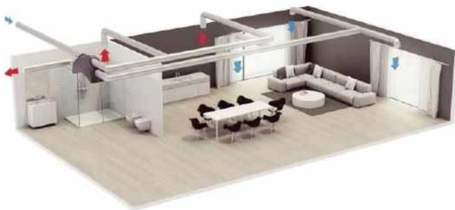
➊ Zasada działania wentylacji mechanicznej z odzyskiem ciepła. BOSPEL
