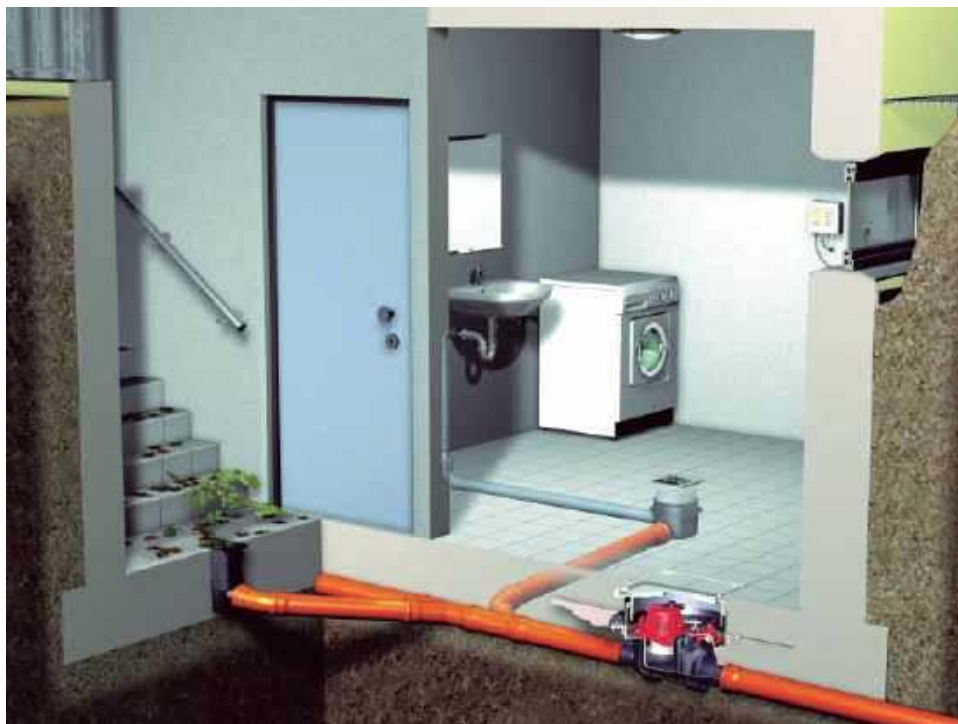
ⓘ Zawór z pompą, która tłoczy ścieki w kierunku przeciwnym do przepływu wstecznego. KESSEL
