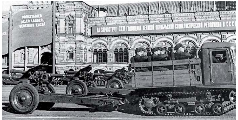
▲ Część artylerii korpusów zmechanizowanych należała do nowych i całkiem niezłych systemów artyleryjskich. Na zdjęciu 122 mm haubica M-30 holowana przez ciągnik STZ-5 (silnik o mocy 52 KM) przewożący także cały dział. Haubice tego typu były eksploatowane jeszcze wiele lat po zakończeniu wojny.
