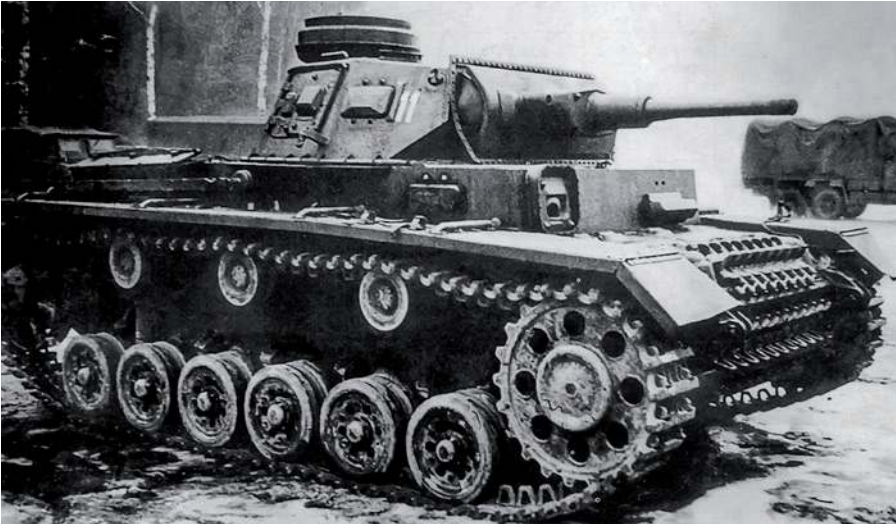
▲ Czołg średni Panzer III Ausf G z armatą 5,0 cm KwK L/42 w wariantcie Tauchpanzer dostosowanym do pokonywania przeszkód wodnych po dnie. Takie czołgi należące do 18. Dywizji Pancерnej 2. Grupy Pancерnej 22 czerwca przekroczyły Bug pod Brześciem.
