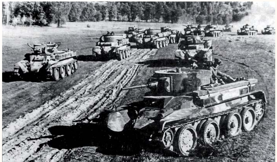
▲ Ćwiczenia z końca lat 30. z udziałem czołgów BT-5 (po prawej) i BT-7 (po lewej). Jak widać tylko pierwszy czołg po lewej jest wyposażony w radiostację. Część wozów ma jeszcze na wieżach oznaczenia przynależności do pododdziału a większość dwubarwny kamuflaż z ciemnobrązowych plam na oliwkowym tle.
