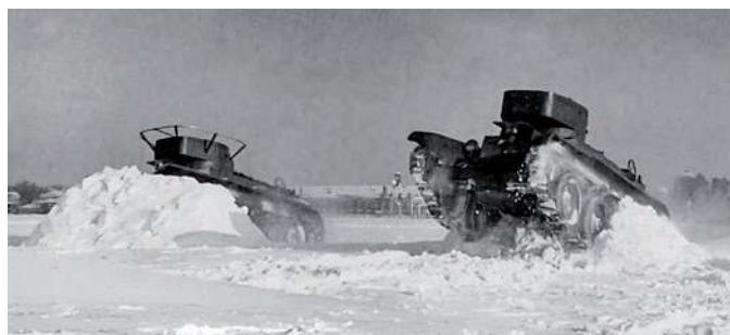
▲ Zimowe ćwiczenia w pokonywaniu przez kierowców czołgów BT-5 zapór utworzonych z ubitego śniegu. Jak widać czołgi tego typu dzięki dużej mocy napędu dość dobrze radziły sobie z tego rodzaju przeszkodami. Po lewej stronie czołg w wersji dowódczej z radiostacją wyposażoną w antenę poręczową.
