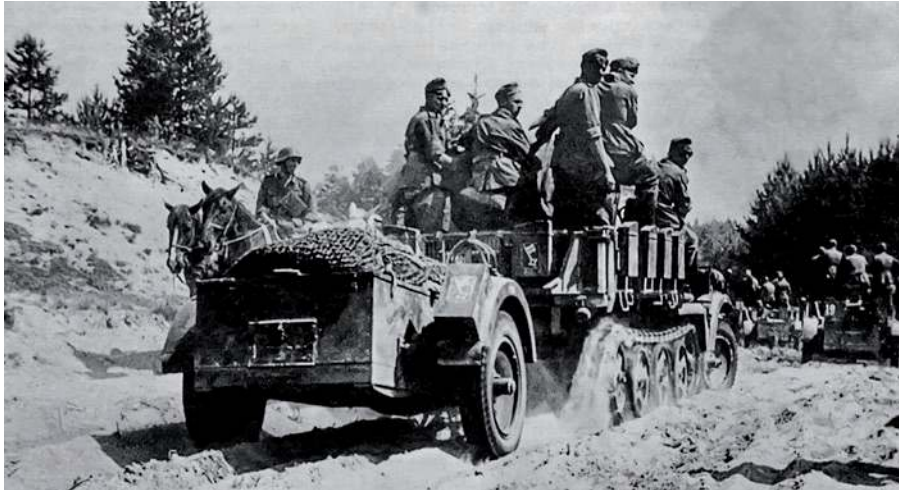
▲ Ciągnik Sd.Kfz 10 z zainstalowanym na skrzyni automatycznym działkiem 20 mm. Pojazd był mobilnym środkiem obrony przeciwlotniczej maszerujących kolumn. Jednocześnie holował przyczepkę z zaopatrzeniem.
