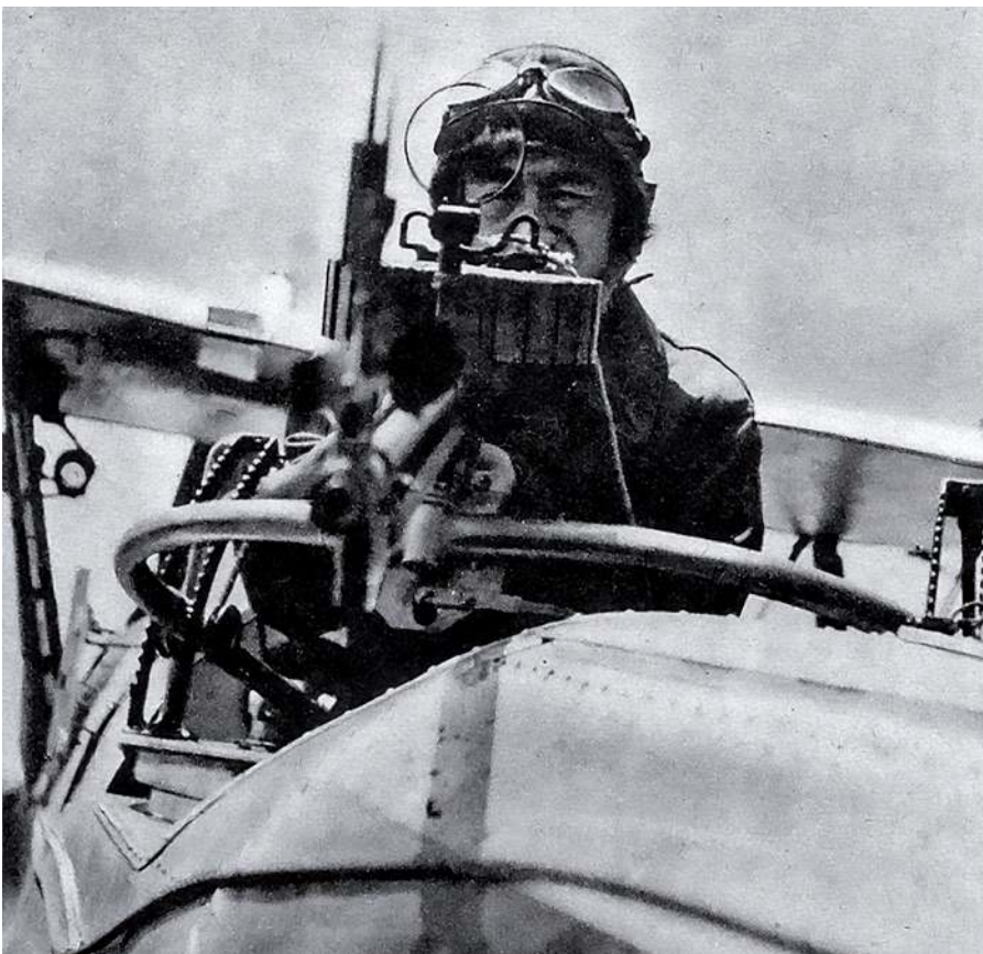
▲ Strzelec samolotu bombowo-torpedowego Typ 89 (Mitsubishi B2M2) za spustem karabinu maszynowego Typ 92 kal. 7,7 mm (licencyjny brytyjski Lewis).
