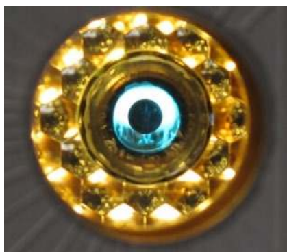
Fotografia 1. Jeden z celów urządzeń w NIF. Pośrodku widać kulistą kapsułę, w której ładowane jest paliwo termojądrowe. Zewnętrzny cylinder to hohlraum, które przekształca przychodzące światło lasera w promienie rentgenowskie, które bombardują kapsułę ciepłem
