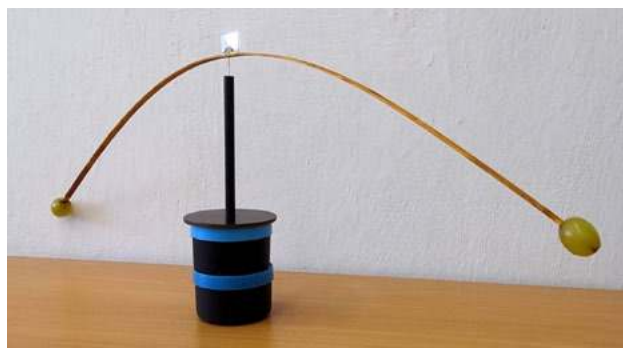
Fot. 1. Wygląd wykonanej listewki do wykrywania materiałów magnetycznych z owocami winogrona na końcach.
