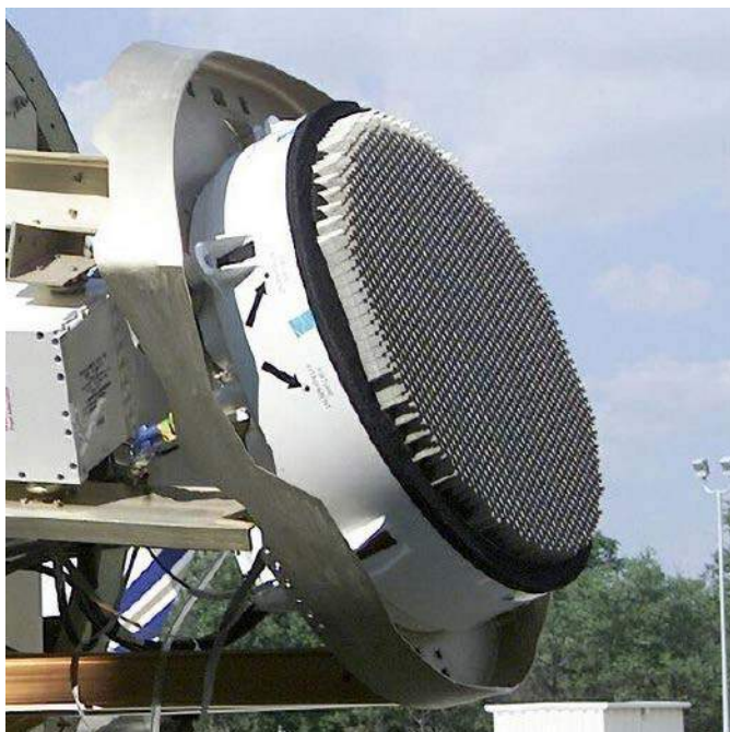
Fotografia 24. Współczesny zespół anten radarowych, wykorzystujący szyk fazowany ( https://t.ly/jglmk )
