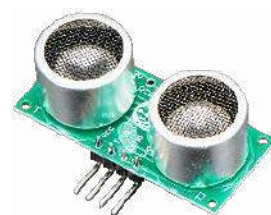
Fotografia 20. Moduł taniego dalmierza ultradźwiękowego RCWL-1601, kompatybilny z HC-SR04 ( https://t.ly/vMx6u )
