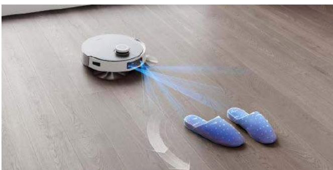
Rysunek 15. Technologia ToF przynosi znaczne korzyści robotyce mobilnej, m.in. automatycznym odkurzaczom – pozwala bowiem na detekcję oraz omijanie przeszkód z dużą precyzją i odpowiednim wyprzedzeniem ( https://t.ly/H_KBd )
