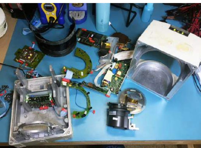
Fotografia 11. Wygląd wnętrza skanera laserowego SICK ( https://t.ly/d-G4P )
