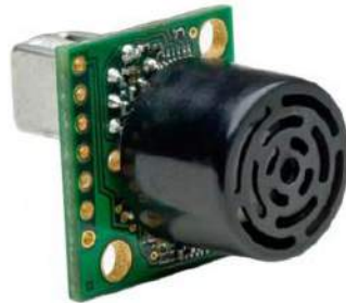
Fotografia 21. Prosty moduł dalmierza ultradźwiękowego – I²CXL-MaxSonar-EZ marki MaxBotix ( https://t.ly/h4u5m )
