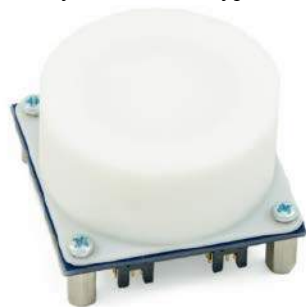
Fotografia 27. Zestaw ewaluacyjny dla modułu V-LD1 z zamontowaną soczewką ( https://t.ly/MSjUD )
