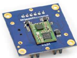
Fotografia 27. Zestaw ewaluacyjny dla modułu V-LD1 z zamontowaną soczewką ( https://t.ly/MSjUD )
