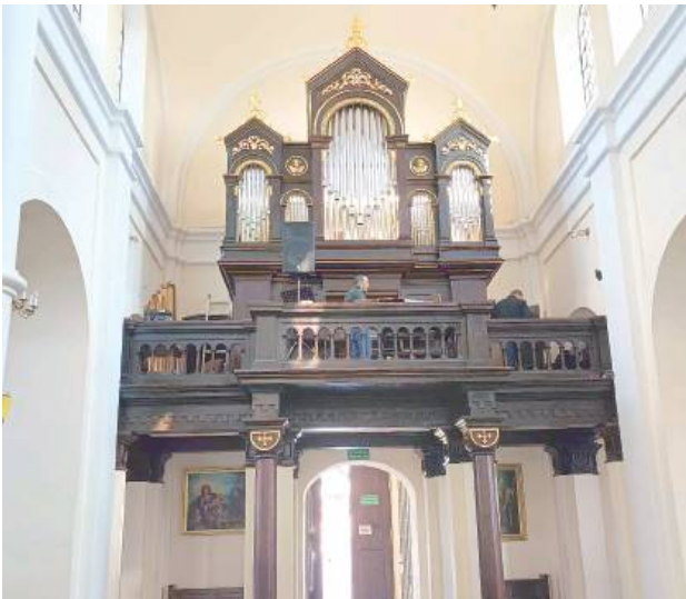
Organy usytuowane są na chórze naprzeciw ołtarza głównego. Szafa organowa jest wolnostojąca, jednoczęściowa, koloru ciemnego brązu (bejca, lakier), ze złoconymi obrzeżami architektonicznymi i detali snycerskich (wici roślinne w naczółkach, żabki, owoce ananasa, uskrzydłone postaci tzw. putta). Instrument posiada 15 głosów (fot. Robert Koślacz)
