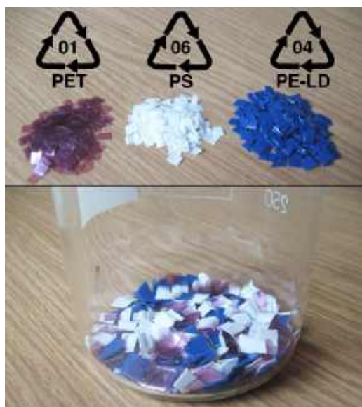
4. Próbkę tworzyw (na górze) zostają zmieszane w zlewie (na dole)
