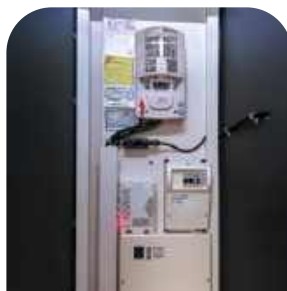
Wewnątrz szafy zlokalizowanej między łazienką a sypialnią znajduje się centrala elektryczno-elektroniczna przyczepy. Stąd też najbliższej do akumulatora, który pozwala na pewną autonomię energetyczną
