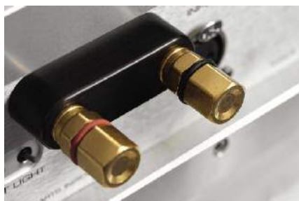
Zaciski głośnikowe są pojedyncze, solidne, bez zadęcia i błyskotek.
