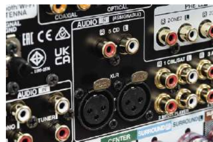
Wejścia XLR w zintegrowanym wzmacniaczu AV, nawet tej klasy, to rarytas.
