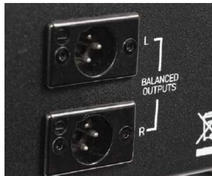
Gniazda są bardzo porządne; XLR-y dostarczył Neutrik.
