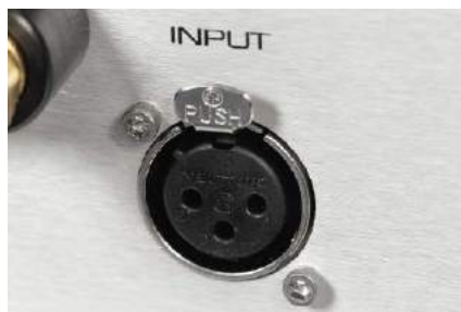
Wzmacniacz ma konstrukcję zbalansowaną, dlatego podanie sygnału do wejścia RCA byłoby tutaj zgniłym kompromisem.
