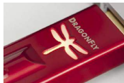
Podświetlane logo ważki to również (kodowany kolorami) wskaźnik parametrów sygnału cyfrowego.
