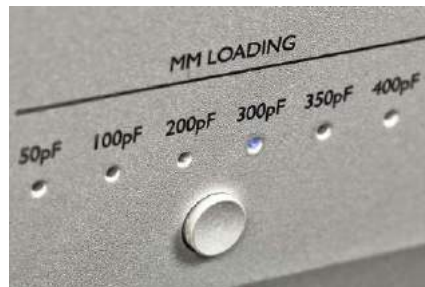
Aby wycisnąć maksimum z posiadanej wkładki, należy już zagłębić się w szczegóły; M6x Vinyl umożliwia wybór obciążenia - nawet pojemnościowego, przydatnego dla wkładek MM.
