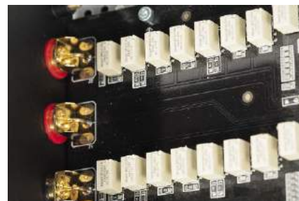
Umieszczone przy gniazdach wejściowych przełączniki załączają odpowiednie dla wybranej konfiguracji zestawy obciążeń.
