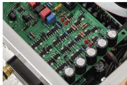
Płytką umieszczoną przy gnieździe wejściowym XLR to jeden z najważniejszych obwodów nowej wersji MxV .
