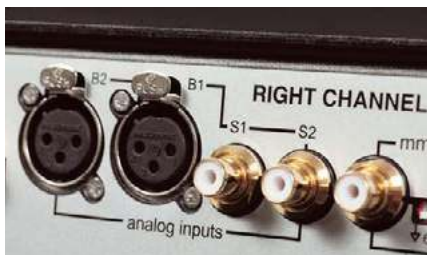
Dla sygnałów liniowych przygotowano dwa wejścia RCA i dwa XLR – tor jest w pełni zbalansowany.
