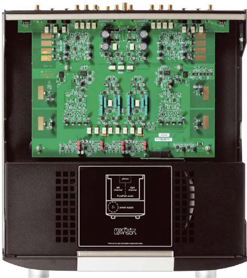
Wewnątrz przedwzmacniacz prezentuje się bardzo schludnie, wręcz elegancko, czego po urządzeniu Levinsona mogliśmy się spodziewać. Całą sekcję cyfrową zasłonięto ekranem, okablowania prawie nie widać.
