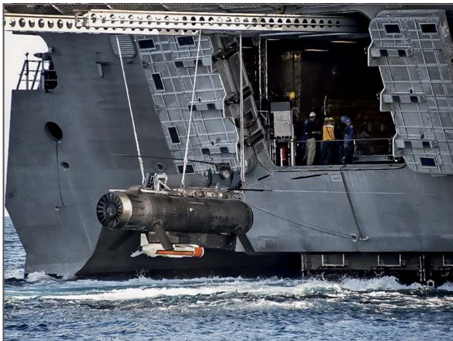
Jednostki klasy LCS (obu typów) nie dysponują własnymi wyrzutniami torped, a ich jedną efektywną bronią przeciwpodwodną są śmigłowce MH-60 Seahawk . Rufowa rampa może być wykorzystana do montażu dodatkowych antenowych zespołów holowanych lub użycia wyspecjalizowanych pojazdów podwodnych – na zdjęciu eksperymentalny UUV systemu RMS przeznaczony do walki minowej.
