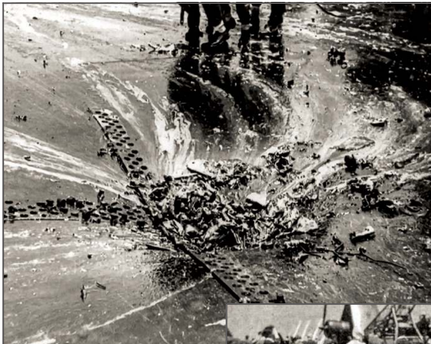
Uszkodzenie pancerza pokładu Formidable'a i „łata” na jego miejscu.
