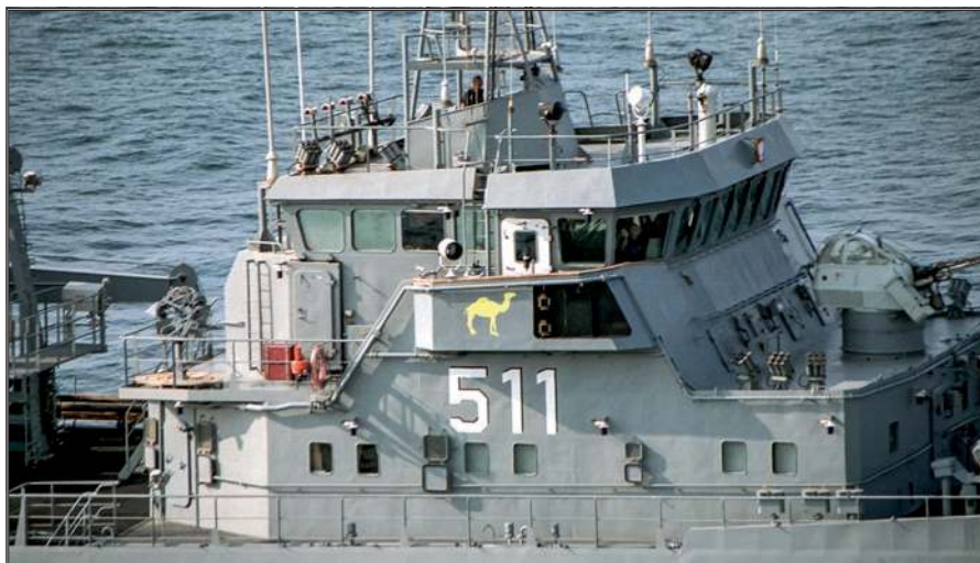
Nadbudówka jednostki z dobrze widocznym numerem taktycznym oraz namalowanym przez załogę wielbłądem – dowodem pobytu na misji w Zatoce Perskiej. Po bokach armaty widoczne wyrzutnie celów pozornych systemu Jastrząb 2 , natomiast za bryłą GSD na burcie widoczna podstawa do montowania czterech przenośnych wyrzutni rakiet przeciwlotniczych Strzała-2M .
