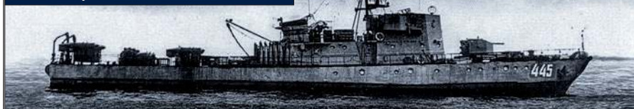
Trałowiec projektu 265, a więc pierwszej wersji rozwojowej tej konstrukcji, łatwo rozpoznawalnej po uzbrojeniu artyleryjskim, czyli dziobowym stanowisku W-11M kal. 37 mm i dwóch podwójnych wkm-ach kal. 14,5 mm na śródokręciu.
