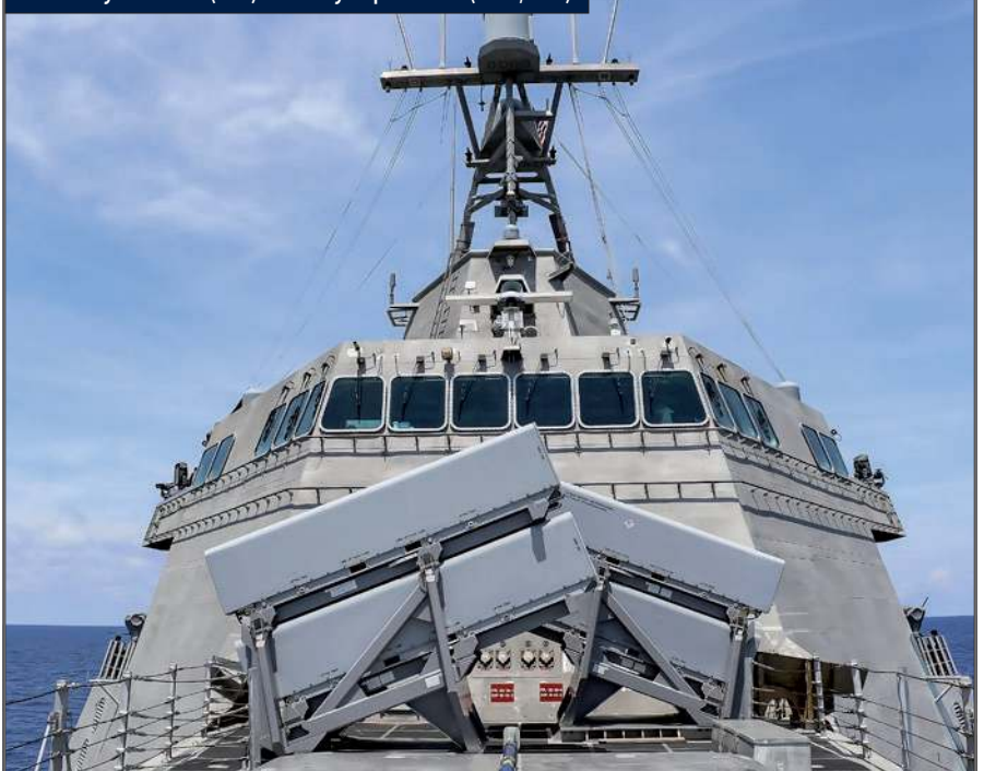
Kontenery startowe (2x4) do nowych pocisków (NSM/JSM).
