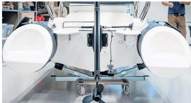
Ultrakompaktowy napęd Z10 ma ułatwić przejście floty na prąd: mniej części, niższe koszty użytkowania i potencjał do szerokiego zastosowania
