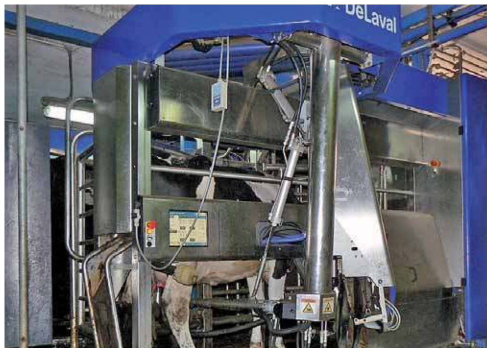
W oborze zainstalowano dwa roboty udojowe. Ruchem zwierząt sterują bramki, które otwierają się tylko w określonej stronie
