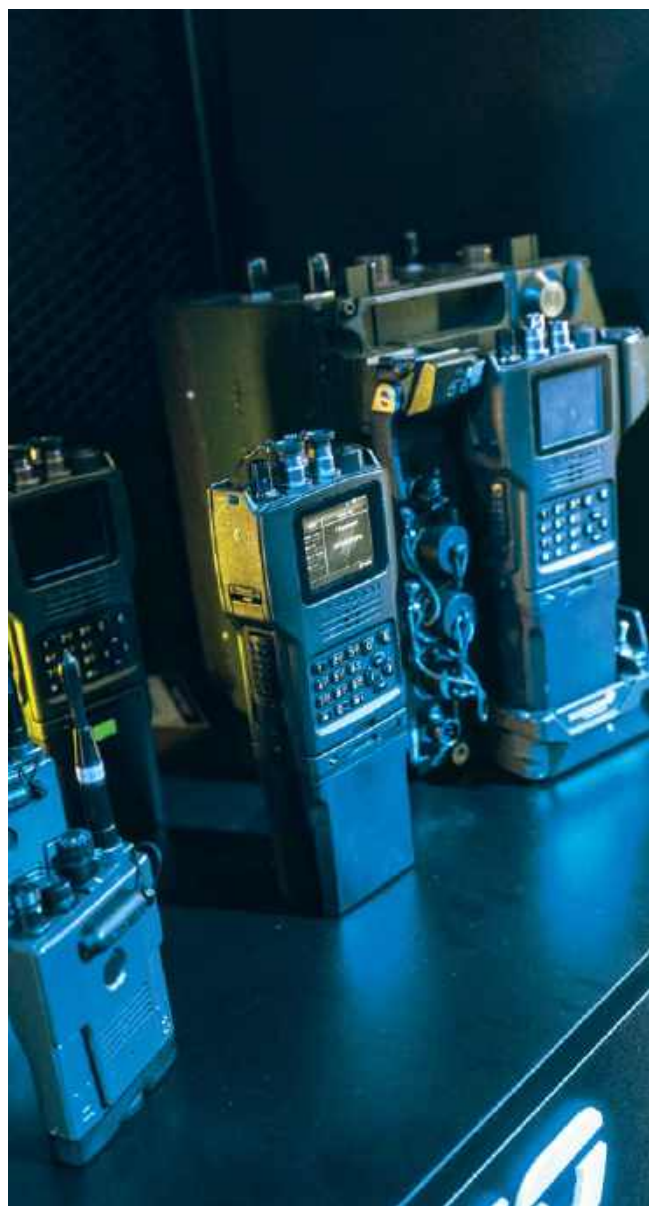
Radiostacja COMP@N-Z H09-Z/1 w odmianie dorecznej (z lewej) i przewoźnej (z prawej) ze wzmacniaczem 50 W
