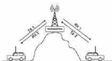
Rys. 2. Zasada działania automatycznego przekąźnika
