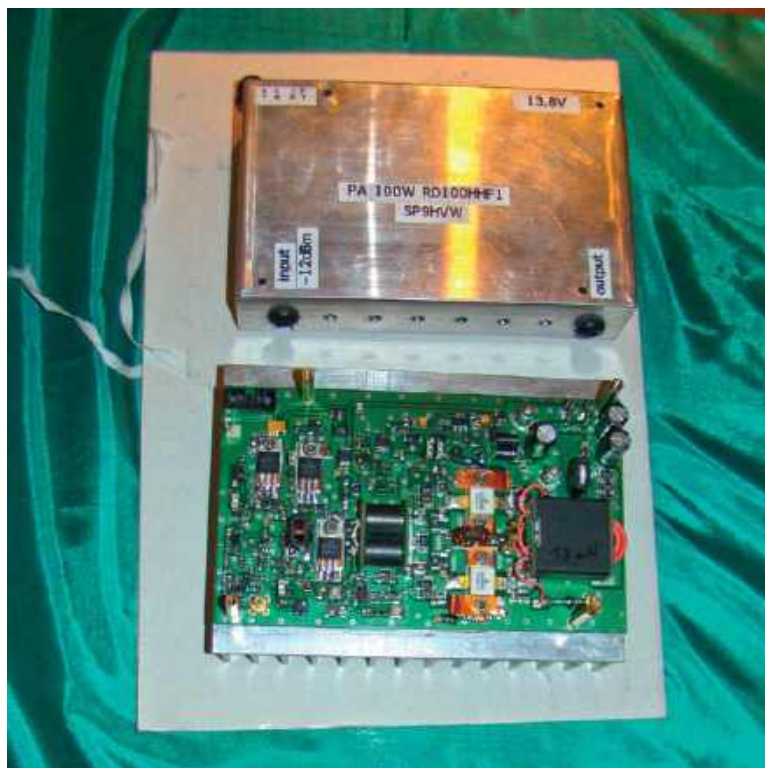
Uniwersalny wzmacniacz HF 100 W wg SP9HVW
