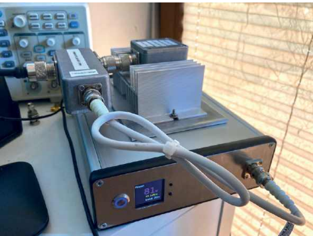
Stanowisko do pomiaru mocy RF wg SP5GW
