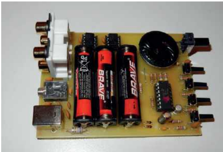
Rys. 5. Płytką drukowaną Winkey-Keyer 3
