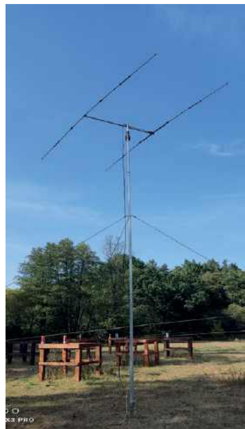
Antena Mosley na wyższe pasma z rotatorem w pełnej okazałości
