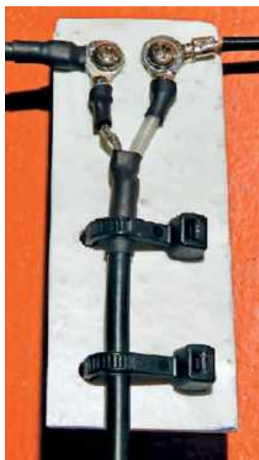
Sposób wykonania zacisków
