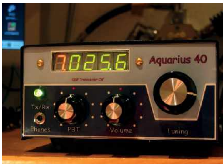
Jeden z transceiverów QRP CW Aquarius konstrukcji SP5DDJ
