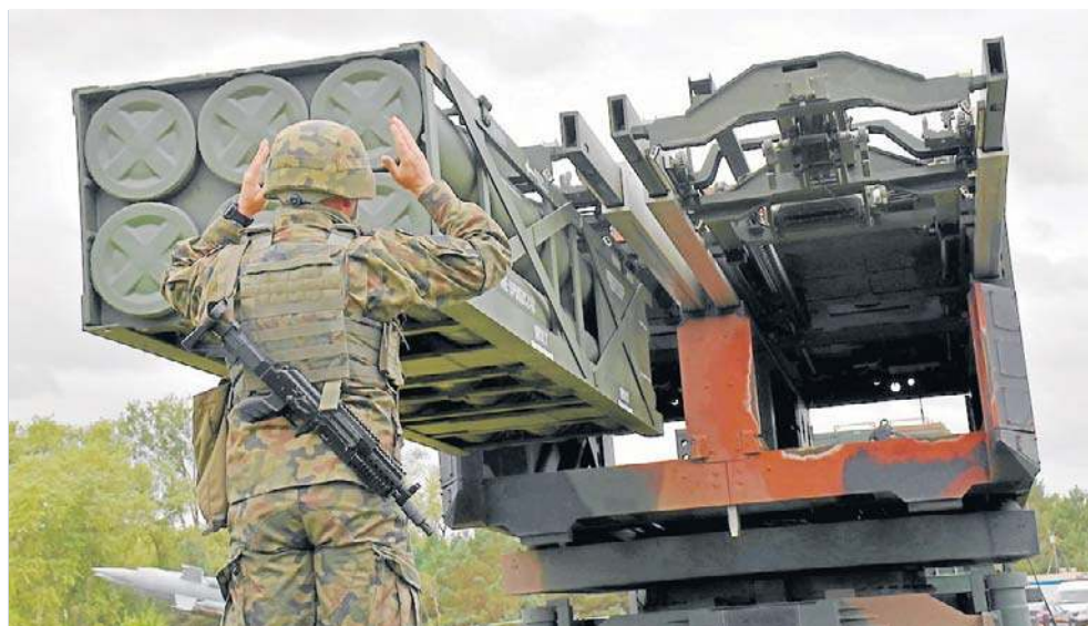
Załadunek rakiet do Homara - K. To wieloprowadnicowa wyrzutnia raketowa
