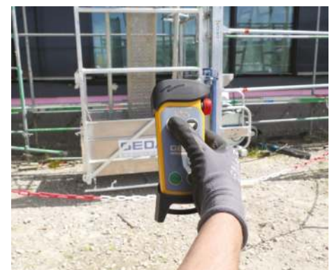
Fot. 9. Moduł sterowania radiowego zastosowany w dźwigu GEDA 200 Z Comfort
