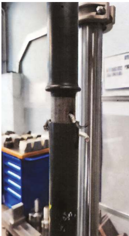
Fot. 3. Widok połączenia po wykonanej próbie wytrzymałościowej. Zdjęcie zostało wykonane podczas badań w Centrum Spawalnictwa Górnośląskiego Instytutu Technologicznego Łukasiewicza 1
