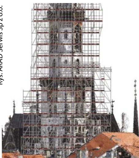
Rys. 3. Wirtualny model 3D projektowanego rusztowania
