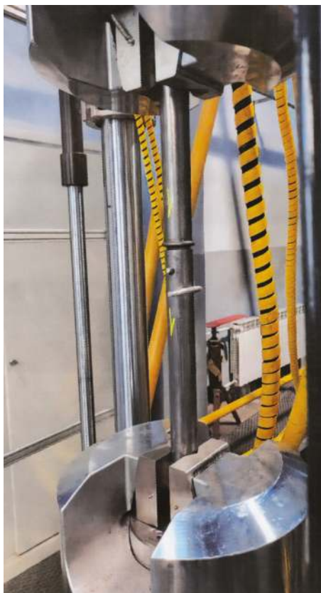
Fot. 2. Przykładowe połączenie elementów rusztowania w maszynie wytrzymałościowej. Zdjęcie zostało wykonane podczas badań w Centrum Spawalnictwa Górnośląskiego Instytutu Technologicznego Łukasiewicza 1
