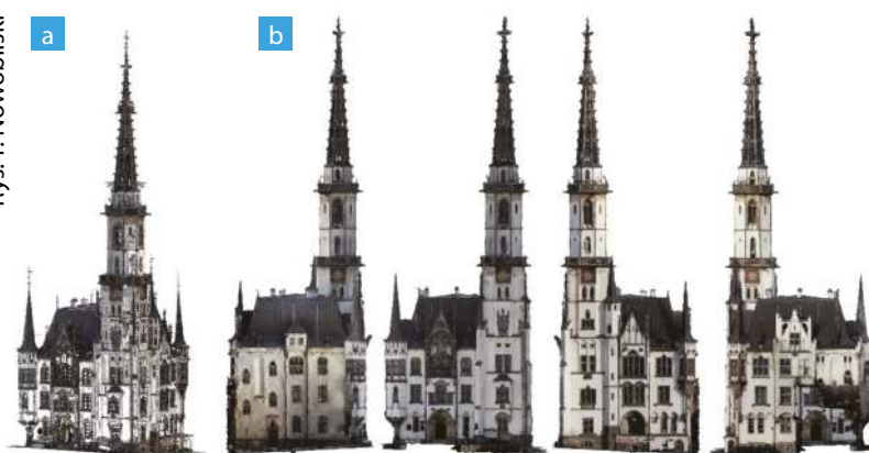
Rys. 2. Inwentaryzowany obiekt: a) widok ogólny na opracowaną chmurę punktów, b) widok na ortofotoplany elewacji, c) widok szczegółowy na opracowaną chmurę punktów
