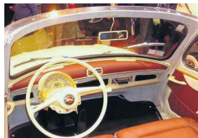
Wnętrze Panharda Dyna Z – tu w wersji kabriolet. Wszystkie wskaźniki, przyciski i przełączniki zgrupowane są przed kierowcą. Nawet we współczesnych samochodach nie zawsze znajdziemy tak funkcjonalne rozwiązania
