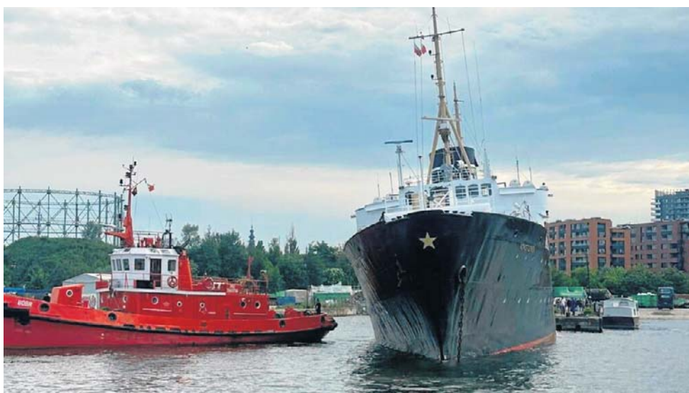
MS Nordstjernen z przechyłem, uszkodzony po uderzeniu w betonowe nabrzeże
