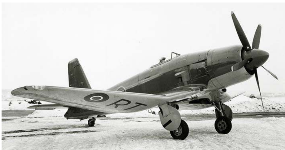
Firecrest miał skrzydła w kształcie litery W widoku z przodu/tyłu. Centroptat miał ujemny wznios -6,5^\circ , a sekcje zewnętrzne dodatni wznios 9^\circ . Do napędu zastosowano 18-cylindrowy silnik w układzie podwójnej gwiazdy Bristol Centaurus 59 z pięciopłatowym śmigłem samoprzestawialnym Rotol.
