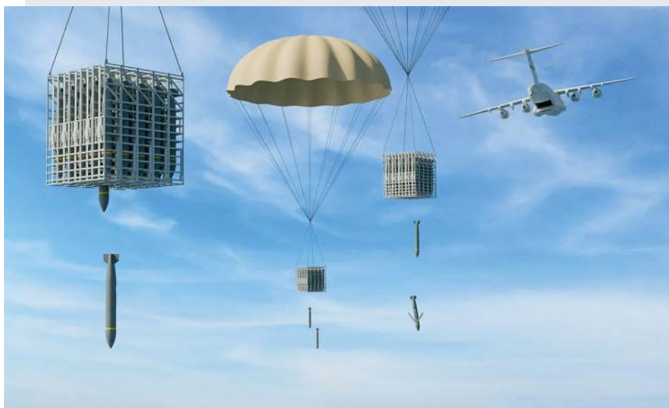
Dragon Cart to system użycia uzbrojenia przez samoloty transportowe z wykorzystaniem wielokomorowych palet, które są wyrzucane z ładowni ze spadochronem. Fot. CoAspire
