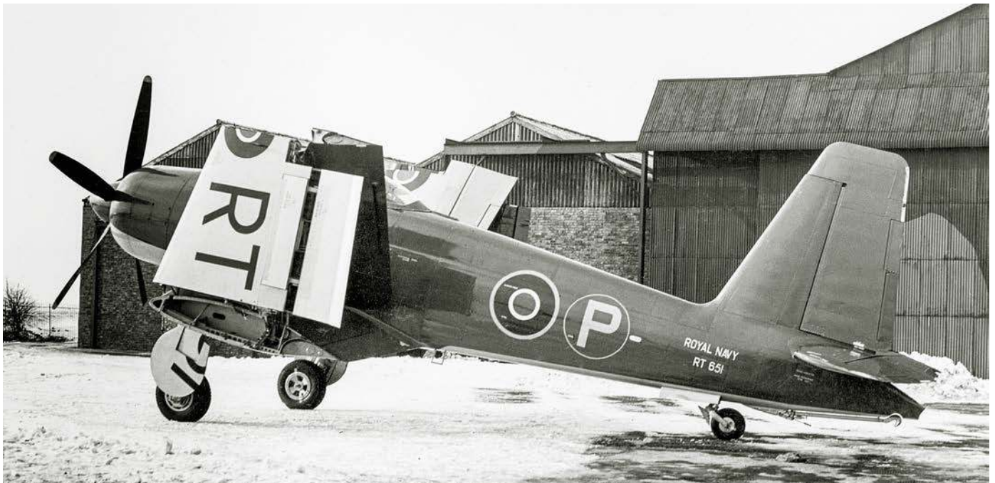
Firecrest miał skrzydła składane w bardzo nietypowy sposób – każde skrzydło składało się w dwóch miejscach, co zmniejszało zarówno szerokość, jak i wysokość samolotu, ułatwiając parkowanie w hangarze lotniskowca.
