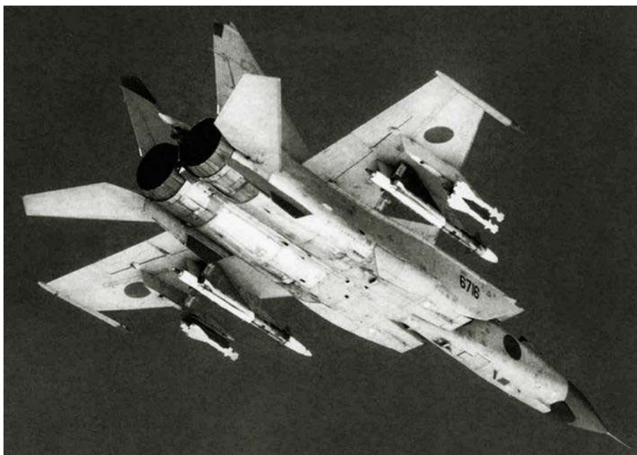
Libijski MiG-25PD uzbrojony obok pocisków średniego zasięgu R-40 (pod lewym skrzydłem R-40RD, pod prawym R-40TD) w pociski krótkiego zasięgu R-60MK podwieszane na zdwojonej wyrzutni montowanej na zewnętrznych pylonach.
