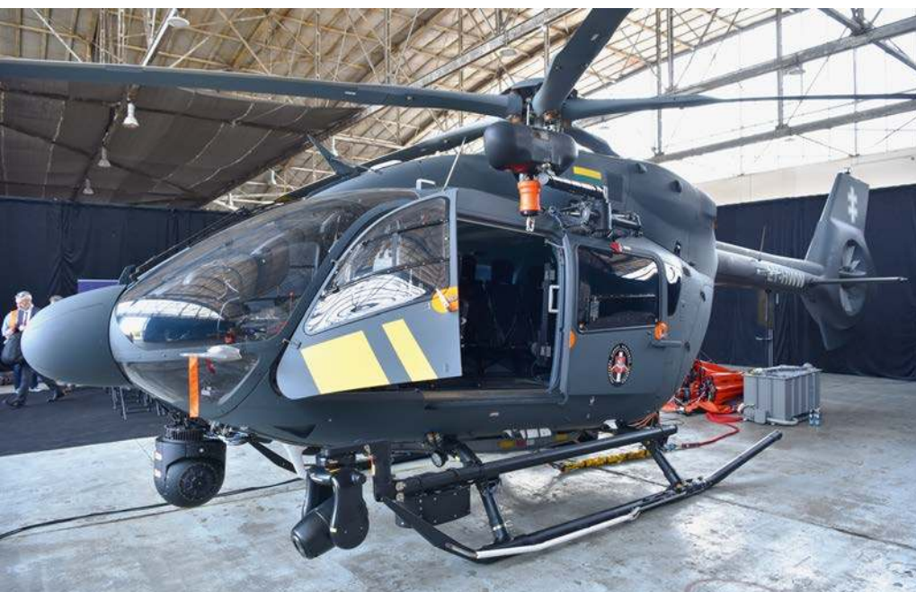
Prezentowany H145D3 miał m.in. radar pogodowy, głowicę optoelektroniczną i reflektor poszukiwawczy.
