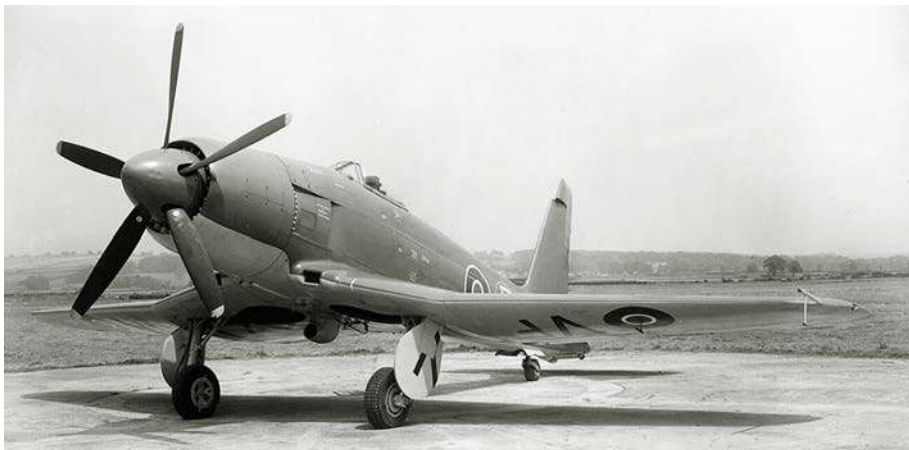
Trzeci zbudowany, a drugi oblatany prototyp Firecresta (VF172). W porównaniu z RT651 wznios zewnętrznych sekcji skrzydeł zmniejszono do 3°, a w układzie sterowania lotkami oraz sterami wysokości i kierunku wprowadzono siłowniki hydrauliczne z układami sztucznego obciążenia sterownic
