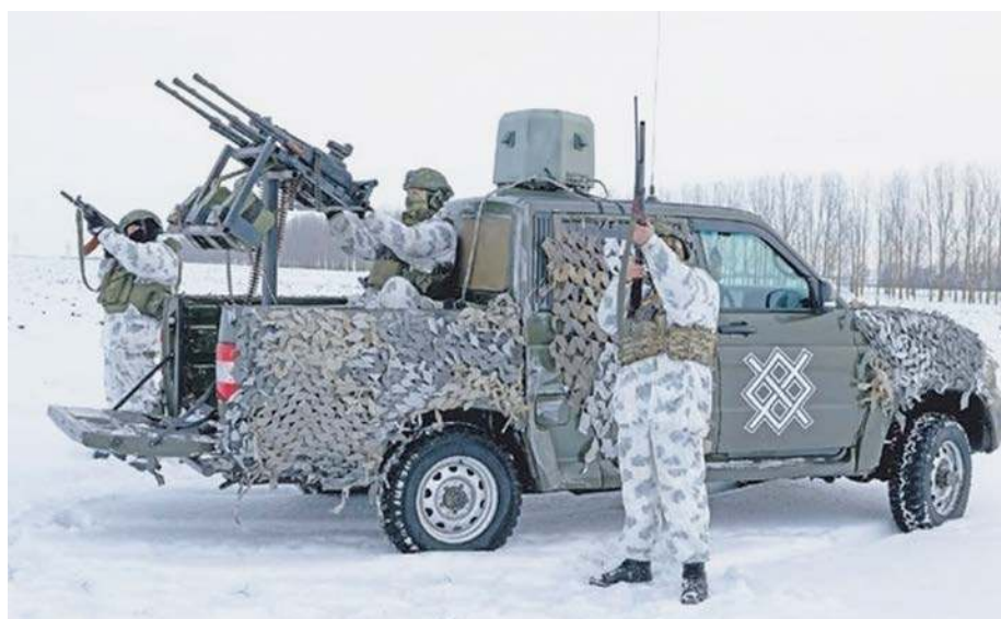
Zajmująca się zwalczaniem ukraińskich dronów dalekiego zasięgu rosyjska mobilna grupa ogniowa, której główną bronią są trzy karabiny maszynowe PKT na improwizowanym stanowisku strzeleckim. Na dachu samochodu widoczny jest również system walki radioelektronicznej.
