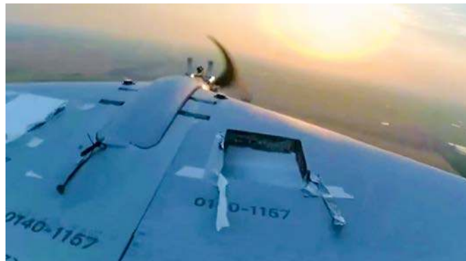
Kadr z momentu przechwycenia rosyjskiego drona BM-35, z którego skrzydła została usunięta bezużyteczna już prostokątna antena systemu Starlink .
