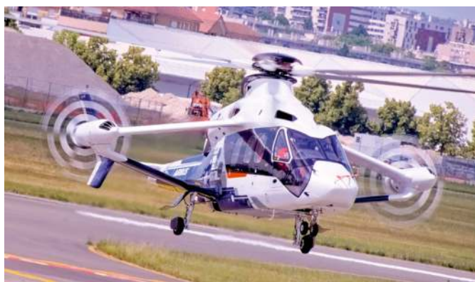
Śmigłowiec eksperymentalny Racer ma na celu przebadanie możliwości zwiększenia prędkości przelotowej wiroplątów przy jednoczesnej redukcji zużycia paliwa.
