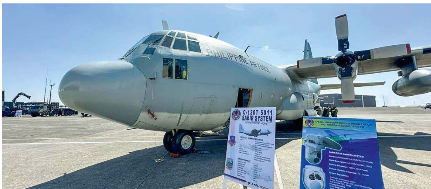
W 2018 roku samolot C-130T nr 5011 został wyposażony w podarowany przez Amerykanów system SABIR służący do obserwacji morza.
