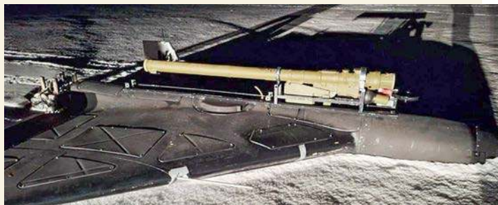
4 stycznia SZU po raz pierwszy natknęły się na Szahida z zainstalowanym przenośnym przeciwlotniczym zestawem raketowym 9K333 Wierba .
