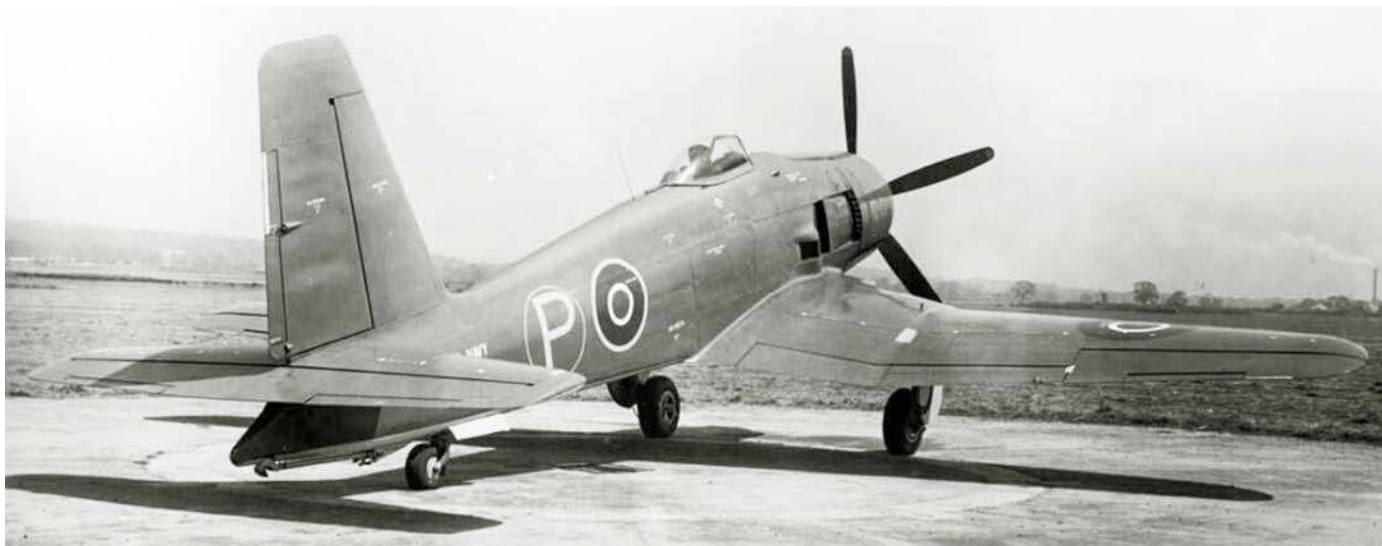
Firecrest w widoku od tyłu. Konieczność kompensacji dużego momentu reakcyjnego śmigła skutkowała zastosowaniem dużego usterzenia pionowego.
