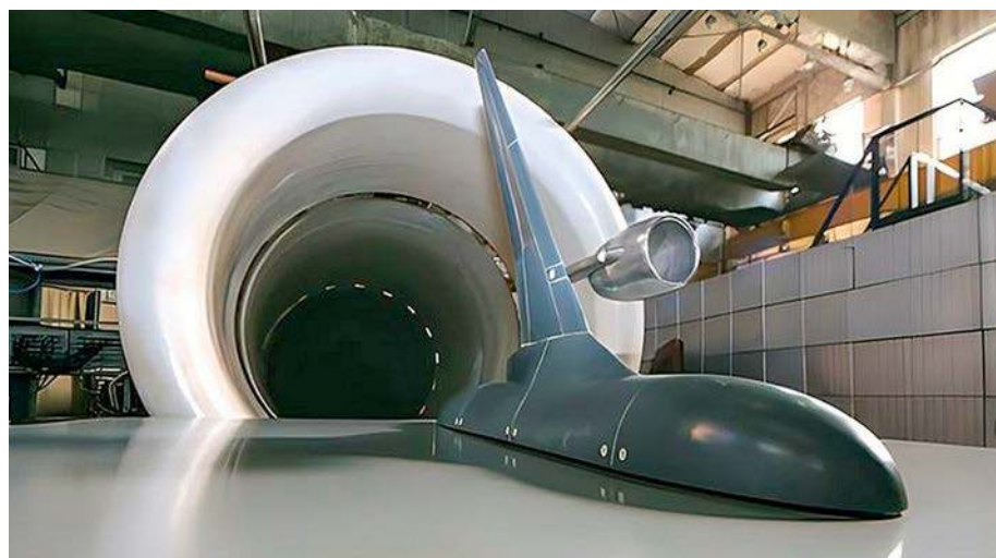
Testowany w tunelu aerodynamicznym CAGI model przyszłego samolotu szerokokadłubowego w jednej z proponowanych konfiguracji. Zwracają uwagę napływy u nasady skrzydeł oraz owalny kształt kadłuba. Fot. CAGI
