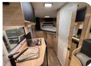
Dzięki ułożeniu łóżka francuskiego wyżej uzyskano miejsce na wysoki i pojemny luk bagażowy w Chausson S695 Sport Line
