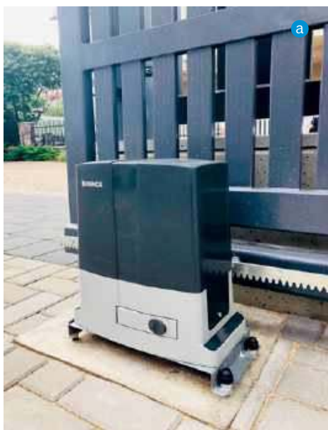
📌 Inne napędy stosuje się do bram wjazdowych przesuwnych (a), inne do rozwieranych (b). Chodzi przede wszystkim o konstrukcję siłowników. Na każdy napęd składają się silnik, centrala sterująca oraz mechanizm przenoszący siłę ciągu silnika na bramę. BENINCA
