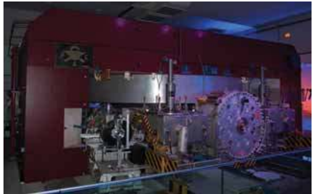
Fot. 1. Synchrocyklotron był pierwszym akceleratorem zainstalowanym w CERN. Przyspieszał cząstki do maksymalnej energii 600 MeV, służąc eksperymentom naukowym przez 33 lata.
