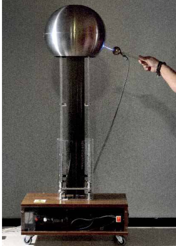
Foto 3. Generator Van de Graaffa zbudowany na WFTIMS Politechniki Gdańskiej przez inż. Jarosława Nowakowskiego Foto: Krzysztof Krzempek
