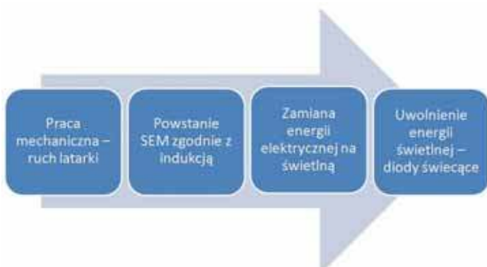
Rysunek 4. Schematyczne przedstawienie zasady zachowania energii w „latarce Faraday’a”. Źródło: opracowanie własne.
