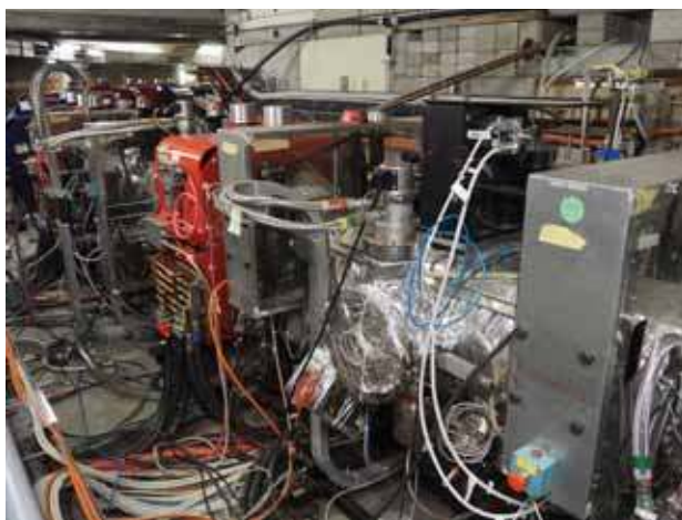
Fot. 5. Antiproton Decelerator (AD) spowalnia antyprotony do energii 5,3 MeV.
