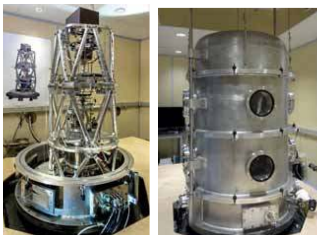
Rys. 2 Zdjęcie wagi Kibble'a ze strony https://www.bipm.org/en/bipm/mass/watt-balance . Po lewej waga otwarta, po prawej waga gotowa do pomiaru.
