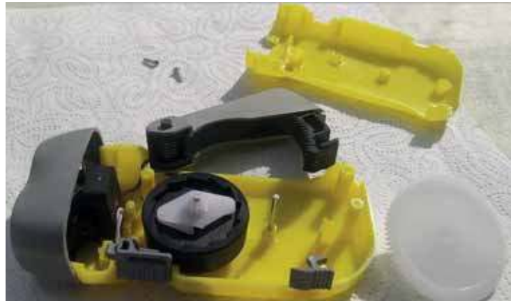
Fotografia 3. A – Latarka z dwoma wyświetlaczami z wykorzystaniem idei dynama; B – wnętrze tak wykonanej latarki.
