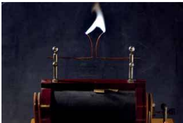
Foto 9. Łuk elektryczny wysokonapięciowy
