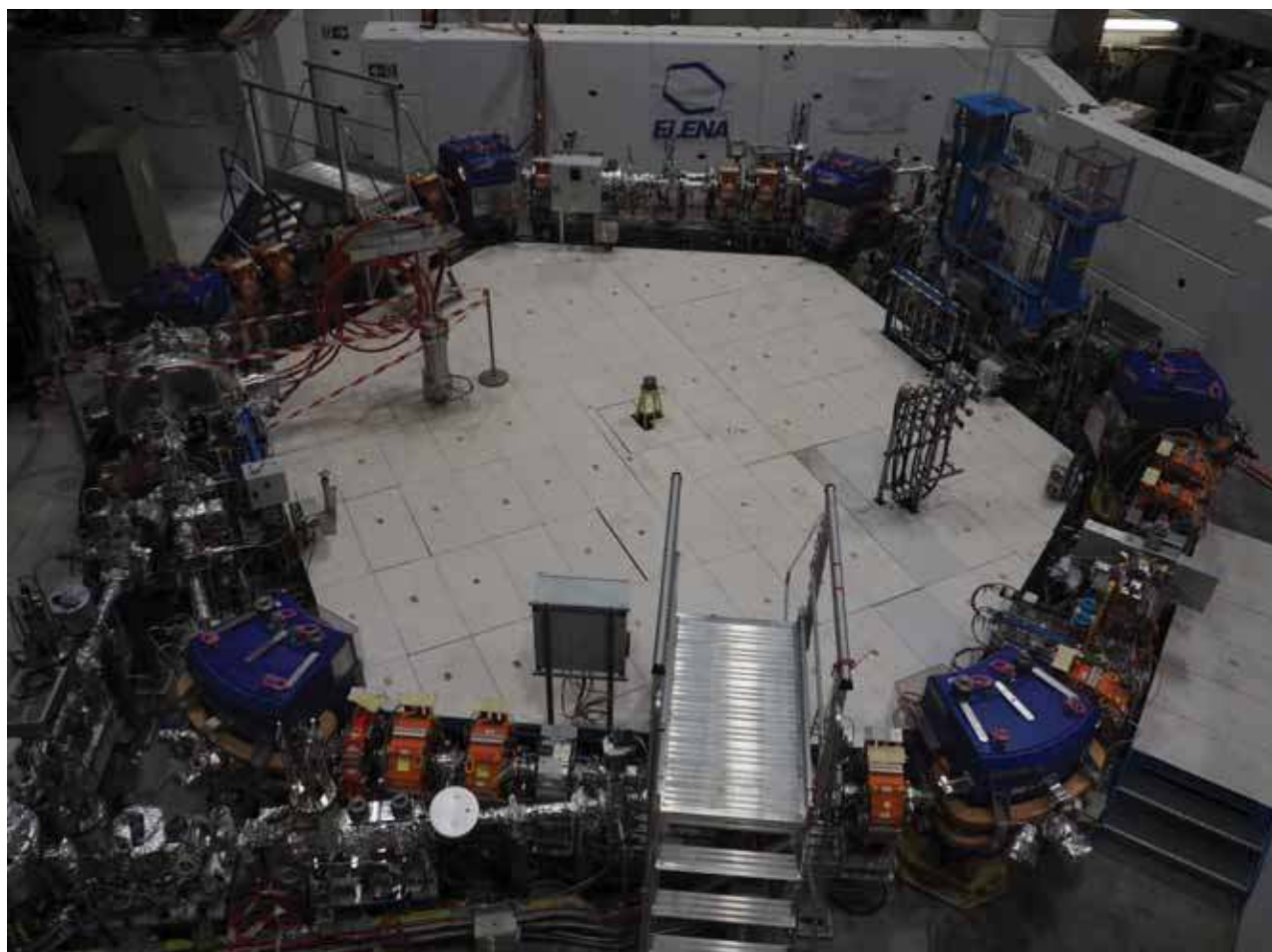
Fot. 6. Znajdująca się w fabryce antymaterii ELENA zmniejsza energię antyprotonów do 100 keV.
