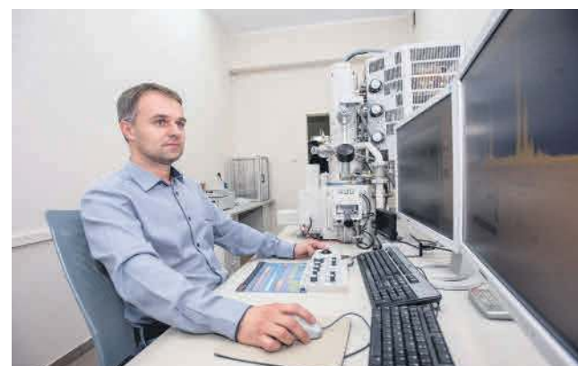
Skaningowy mikroskop elektronowy (SEM) HITACHI SU8010, wyposażony w detektory SE, detektor BSE i detektor EDX
