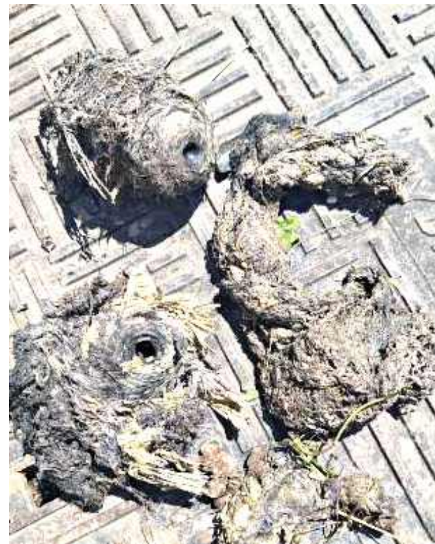
Przyczyną problemów okazały się trzy mopy, które zostały częściowo zmielone przez urządzenia pracujące w systemie kanalizacyjnym
