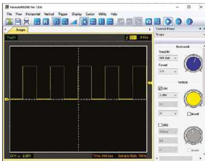
Rysunek 3.21. Przebieg prostokątny zgodny ze standardem TTL wytworzony przez układ z buforem tranzystorowym z rysunku 3.20 i program z listingu 3.8
