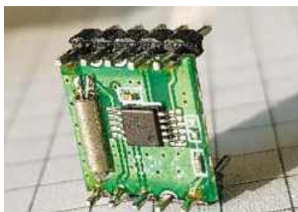
Rysunek 13. Układ scalony radia FM zamontowany w module i złącze o rastrze 2 mm
