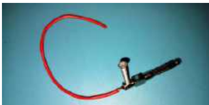
Rysunek 11. Metalowy element wtyczki bananowej typu Amass po przylutowaniu przewodu
