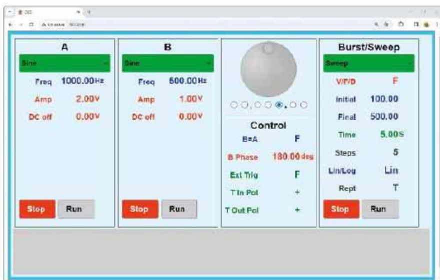
Ekran 1. Generator funkcyjny udostępnia panel sterowania dostępny przez przeglądarkę internetową, który umożliwia zdalną obsługę urządzenia przez Wi-Fi
