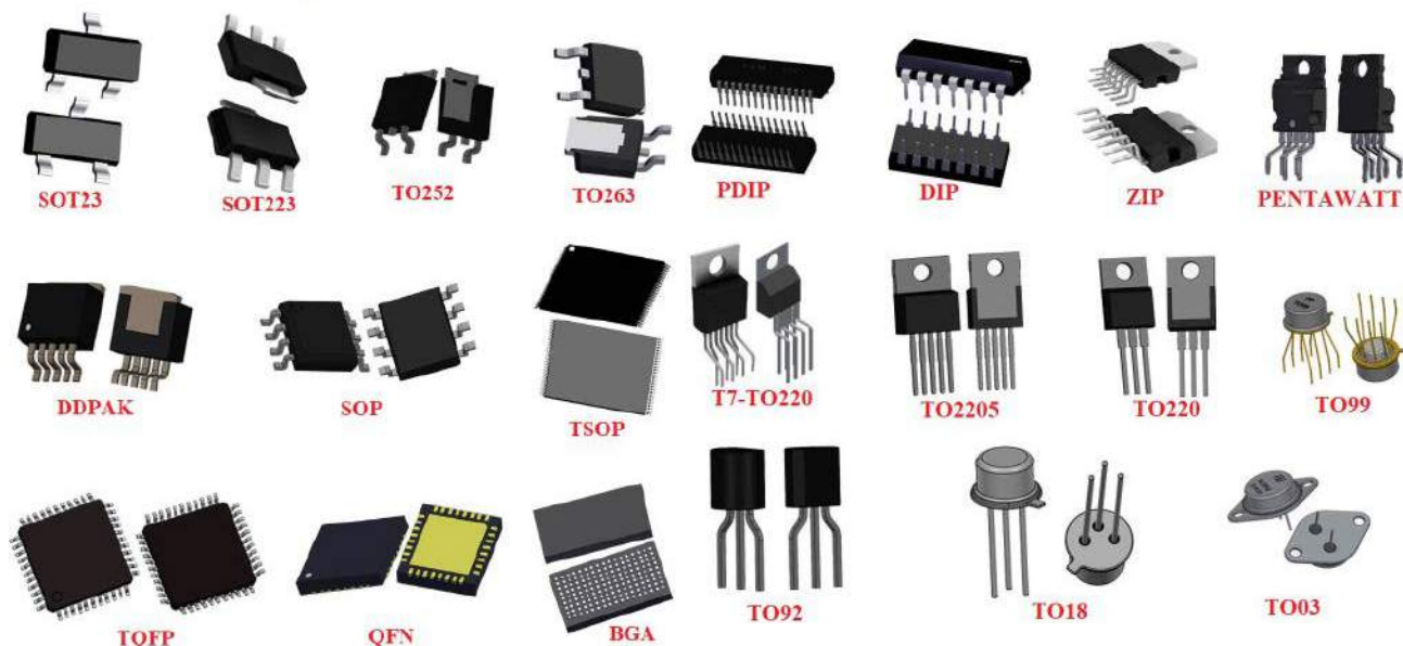
Rysunek 10. Różne rodzaje obudów układów scalonych (źródło: components101.com/articles/different-ic-package-types-and-which-one-should-you-select )
