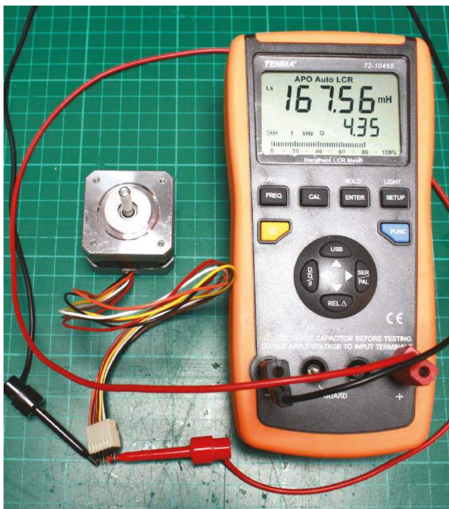
Rysunek 13. Zastosowanie miernika RLC do pomiaru indukcyjności uzwojeń silnika krokowego.
