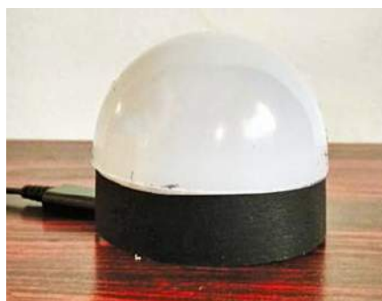
Rysunek 15. Osłona rozpraszająca umieszczona na tekturowej podstawie
