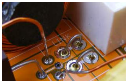
Rysunek 11. Płytkę posiada opcję biwiringu. Jeśli opcja ta nie jest używana to sekcje niskotonowa i wysokotonowa są połączone jak na rysunku powyżej.
