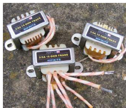
Rysunek 4. Laminowane cewki LS3/5a są dostępne na eBayu. Producent nie podaje, czy zastosowano w nich Radiometal czy stop żelaza z krzemem, ale brzmią dobrze.
