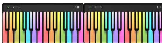
Fotografia 30. Klawiatura sterująca Roli Lumi (a), mając dwa egzemplarze tego modelu można uzyskać większą klawiaturę (b)
