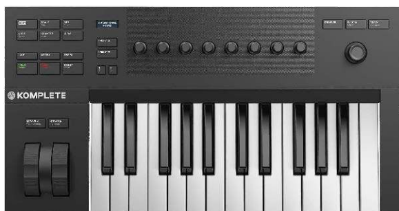
Fotografia 9. Native Instruments Komplete Kontrol A25, kontroler zaprojektowany do współpracy z oprogramowaniem Native Instruments
