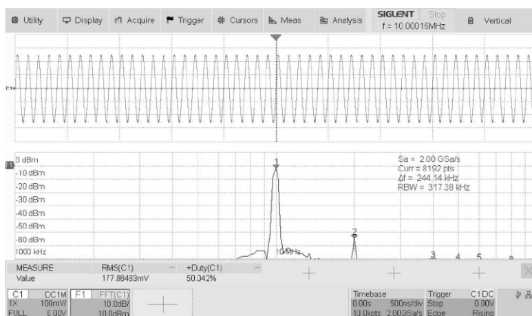
Rysunek 4. Harmoniczne przebiegu wyjściowego generatora
