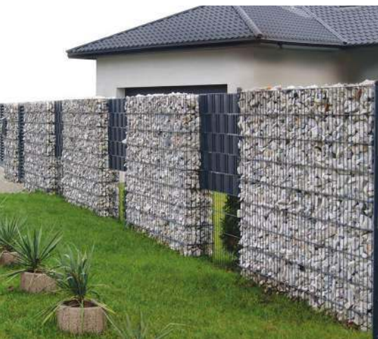
📌 Gabiony stanowią skuteczną barierę przed hałasem ulicznym, ponieważ ze względu na wypełnienie mają właściwości dźwiękoszczelne. KONSORT
