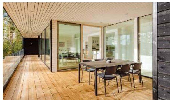
📍 Taras wykończony drewnem termowanym jest odporny na biodegradację i wycieki żywicy. JAF POLSKA
