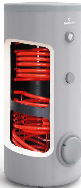
W ymiennik c.w.u. z trzema węzłownicami, do którego można podłączyć jednocześnie pompę ciepła, kolektory słoneczne i kocioł C.O. GALMET
