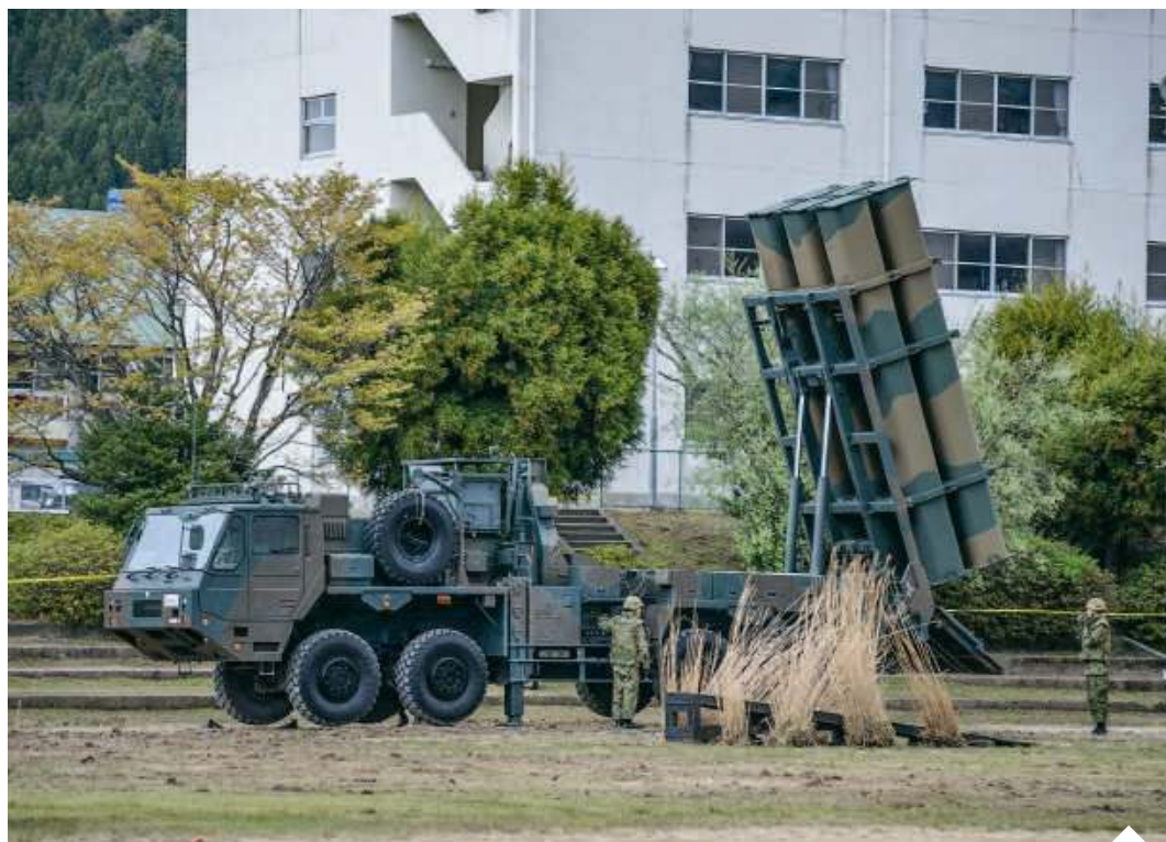
Pociski manewrujące Typ-12 naprowadzane są inercyjnie, za pomocą systemu GPS i radaru z anteną z aktywnym skanowaniem elektronicznym (AESA) | fot. Wikipedia/d
