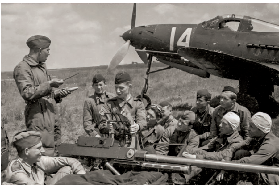
▲ Radzieccy mechanicy zapoznają się z główną bronią samolotu P-39 - 37 mm działkiem M-4.
