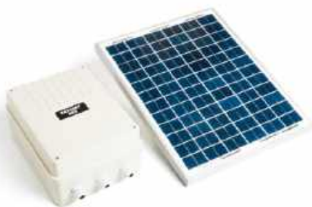
Zestaw solarny do bram wjazdowych składający się z panelu solarnego, kontrolera ładowania i dwóch akumulatorów 12 V/9 Ah. Zestaw można podłączyć do napędu bramy przesuwanej lub skrzydłowej. Zasilanie solarne umożliwia montaż napędu do bramy tam, gdzie nie ma dostępu do zasilania elektrycznego. SUKCES GROUP
