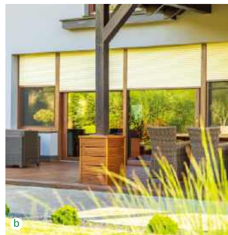
📍 Roleta natynkowa w kasecie, montowana na elewacji gotowego okna, widoczna z zewnątrz (a SOMFY). Roleta podtynkowa, ukryta w ścianie nad oknem; montuje się ją na etapie wznoszenia ścian i tynku (b KRISHOME).
