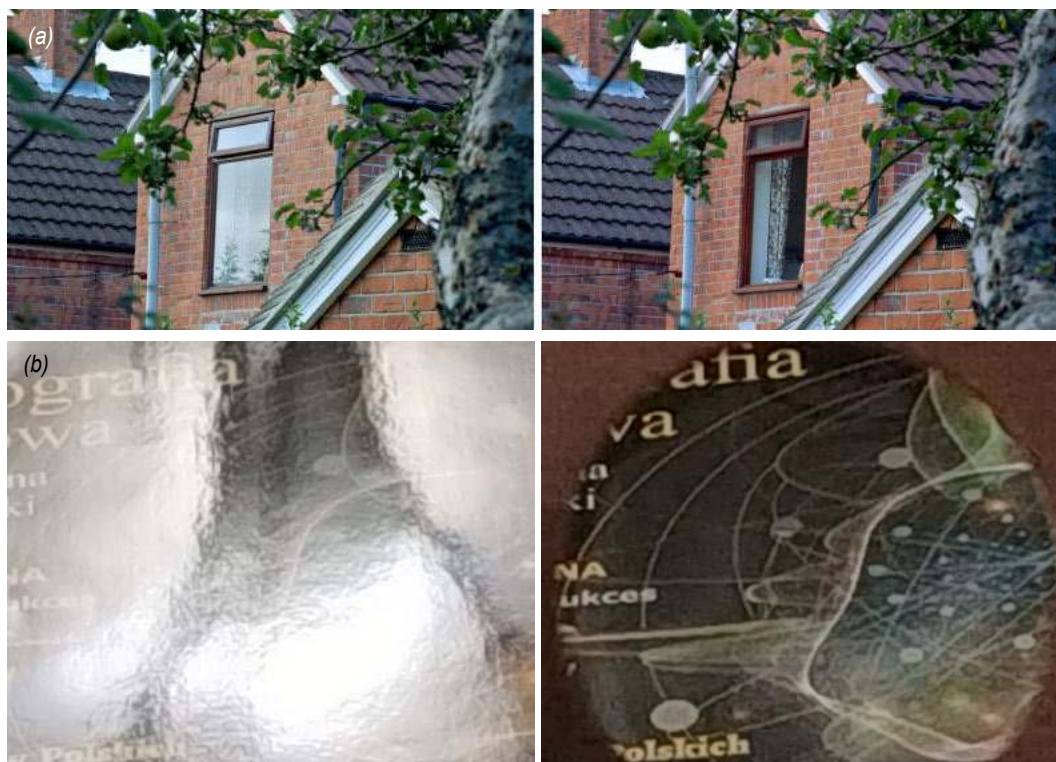
Rysunek 11. (a) Zdjęcie po lewej wykonano bez filtra (światło odbite od okna jest spolaryzowane w płaszczyźnie pionowej). Na zdjęciu po prawej z użyciem filtra polaryzacyjnego światło odbite od okna zostało wyeliminowane. Źródło: https://en.wikipedia.org/wiki/Brewster%27s_angle#/media/File:Polariser-demo.jpg [11].
