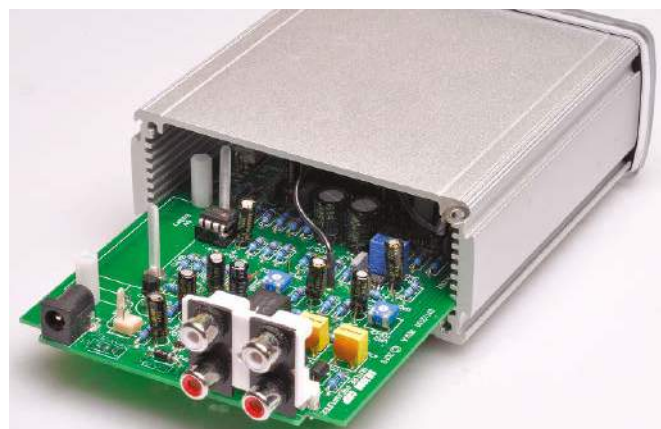
Gotową płytkę PCB po prostu wsuwa się w wytłaczaną obudowę, tak że oś potencjometru i przełącznik znajdują się na przednim panelu. Nie ma potrzeby przykręcania płytki PCB, ponieważ jest ona trzymana mocno w slotcie przez przednią i tylną część obudowy
