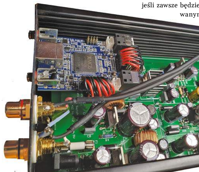
Widok podczas montażu ze zdjętym panelem dolnym. Następnie wsuwamy płytkę tłumika w najniższe sloty (na fotografii najwyższe), elementami w kierunku płytki głównej na samej górze (na fotografii widoczna dole)
