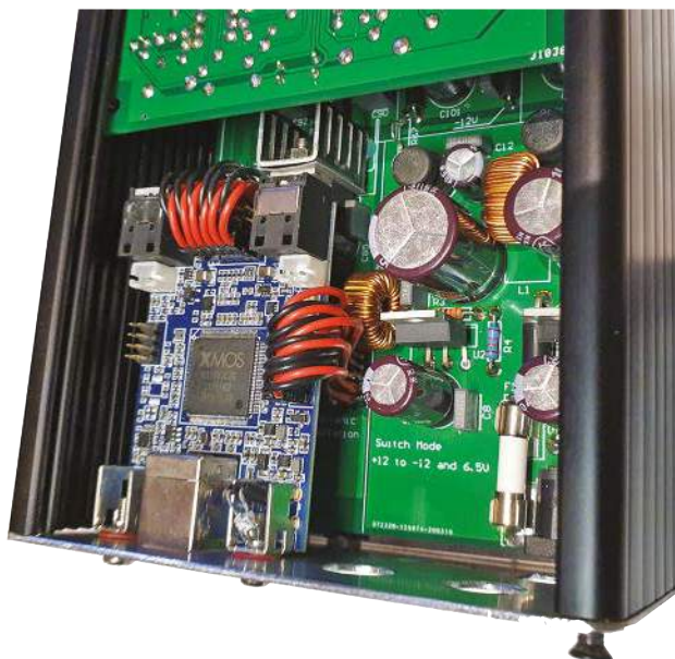
MCHStreamer jest mocowany do tylnego panelu za pomocą zestawu tulei izolacyjnych na śrubach M3, podkładek izolacyjnych oraz izolacyjnej ramki gniazda USB. Nie zapomnij o tym! Widok od spodu i od tyłu
