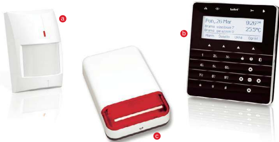
➊ Elementy systemu alarmowego: pasywna czujka podczerwieni PIR (a), manipulator (b), syrena alarmowa (c). SATEL
