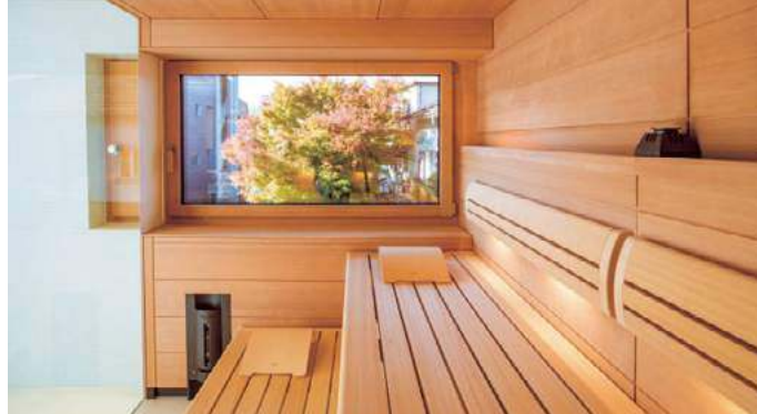
Sauny wykonuje się z drewna odpornego na działanie wilgoci i wysokiej temperatury, podanego obróbce termicznej, np. ze świerku lub sosny skandynawskiej, jodły kanadyjskiej, cedru. KLAFA
