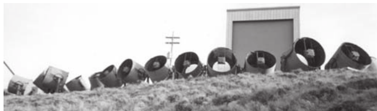
Rysunek 16. Teleskopy eksperymentu Fly's Eye.
