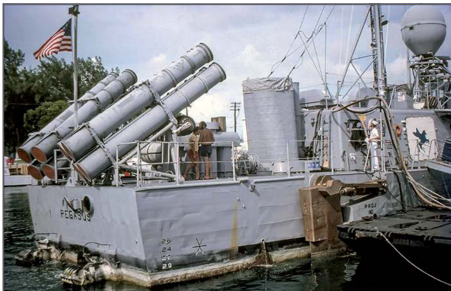
Widoczne szczegóły mocowania wyrzutni rakiet przeciwokrętowych do pokładu wodolotu na rufie.
