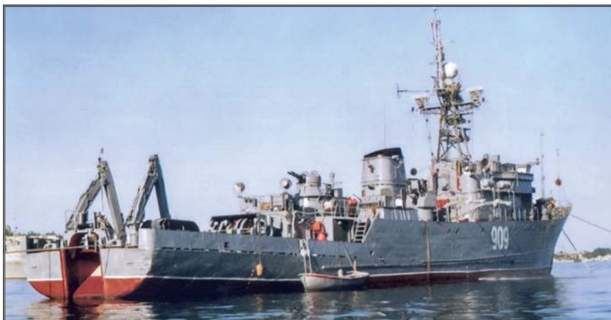
Widok na charakterystyczną rufę trałowców rodziny projektowej 266/266M. Dobrze widoczne żurawie trałowe i miejsce, z którego stawiano do wody wszystkie przenoszone elementy trałów oraz systemów poszukiwania i niszczenia min.
