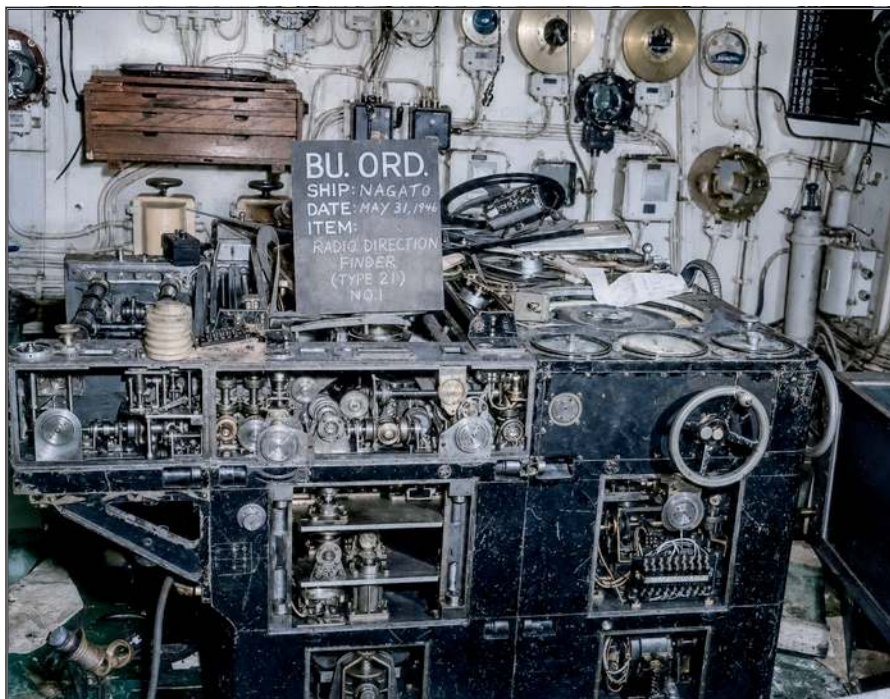
Japoński konżurator (98-Shiki Ho-Sha) na pokładzie okrętu liniowego Nagato , sfotografowany przez BuOrd (Bureau of Ordnance) w maju 1946 r. Choć precyzyjnie wykonany, w 1944 r. należał już do konstrukcji przestarzałych. Widoczny na zdjęciu rozbudowany układ przekładni i krzywek zwiększał podatność mechanizmu na wstrząsy od salw własnej artylerii oraz na drgania kadłuba. Amerykańscy inżynierowie byli pod wrażeniem jakości wykonania detali, ale jednocześnie zaskoczeni brakiem automatyzacji i integracji.
