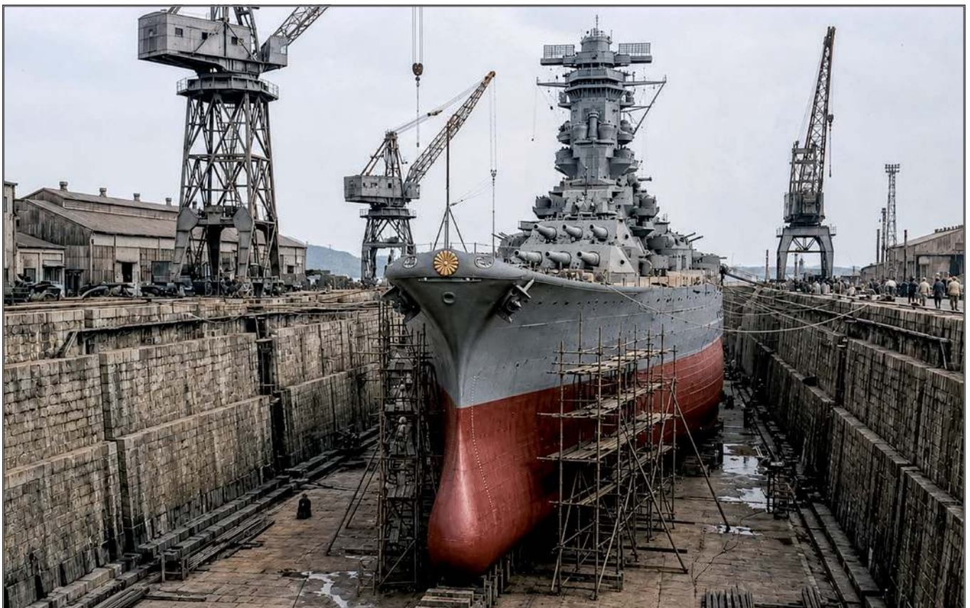
Rekonstrukcja cyfrowa ukazująca sekcję dziobową superdrednoty w doku remontowym. Perspektywa ta idealnie uwypukla gruszkę dziobową, która była jednym z najbardziej udanych elementów japońskiego projektu, znacząco redukując opór falowy kadłuba. Obraz pozwala również na analizę rozmieszczenia wież artylerii głównej i pomocniczej względem osi pionowej okrętu, co jest kluczowe dla zrozumienia stabilności jednostki jako platformy artyleryjskiej.
