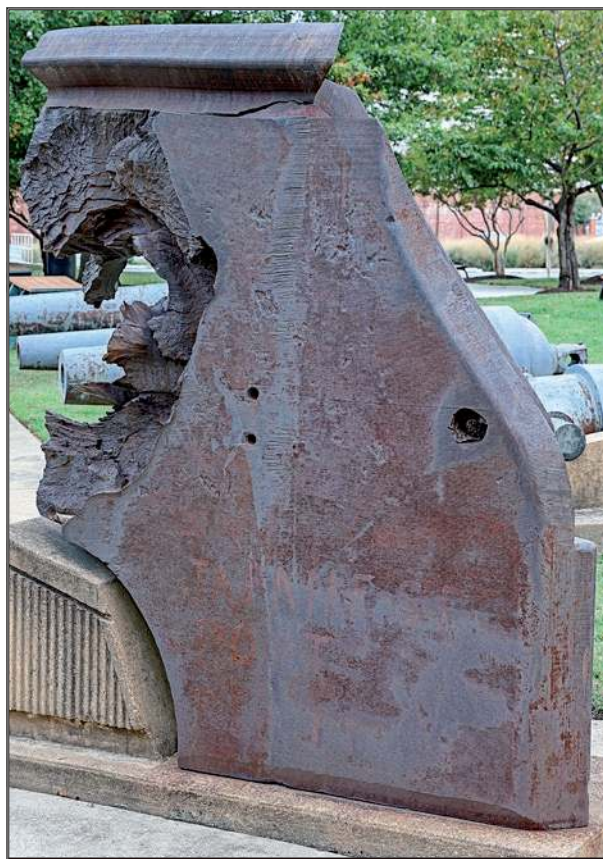
Fotografia eksponatu w U.S. Navy Museum przedstawia płytę czołową wieży o grubości 650 mm przeznaczoną dla Shinano po penetracji amerykańskim pociskiem APC kal. 406 mm. Testy balistyczne wykazały, że efektywność pancerza VH była o 15–30 proc. niższa od teoretycznej. Zdjęcie ukazuje postrzępione krawędzie i pęknięcia biegnące w głąb płyty – wynik niskiej czystości metalurgicznej i błędów w procesie hartowania.
