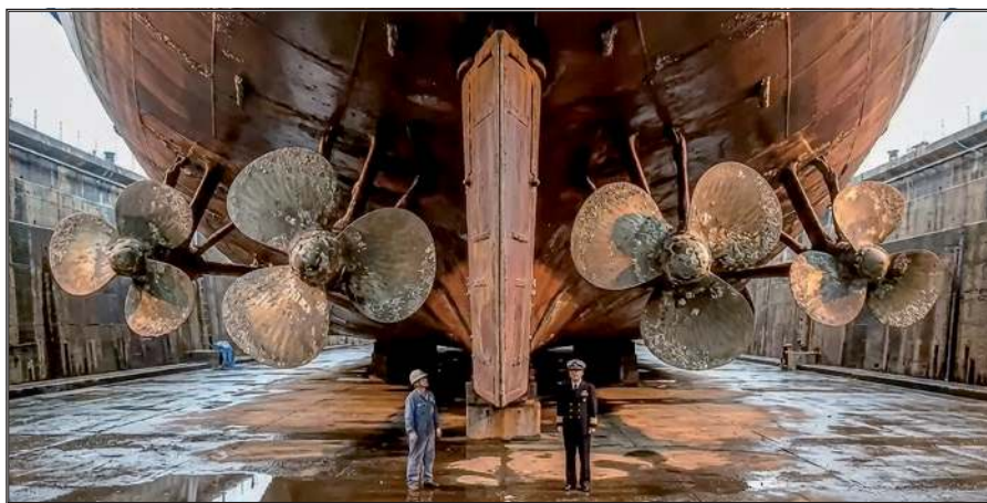
Rekonstrukcja rufy superdrednota, wykonana w ramach „Projektu Yamato”. Dobrze widoczny układ czterech trójłopatowych śrub napędowych o średnicy 6 m oraz charakterystyczny, podwójny system sterów (główny i pomocniczy w osi symetrii). Analiza tej części kadłuba pozwala zrozumieć wyzwania związane z manewrowością tak ogromnej jednostki oraz problematykę vibracji przenoszonych na konstrukcję rufy podczas rozwijania prędkości maksymalnej.
