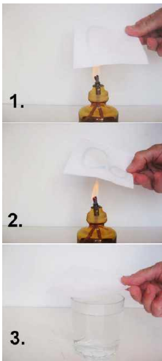
1. Napis sporządzony roztworem chlorku kobaltu(II) po umieszczeniu nad płomieniem palnika (1) ujawnia się w postaci niebieskich liter (2). Działanie pary wodnej ponownie ukrywa napis (3)
