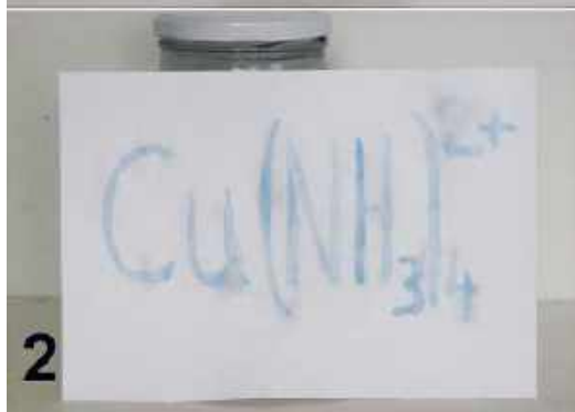
4. W zakręcanym stoiku z wodą amoniakalną umieść kartkę papieru z napisem sporządzonym roztworem soli miedzi (1). Po wyjęciu arkusza zobaczysz niebieskie znaki tekstu (2)
