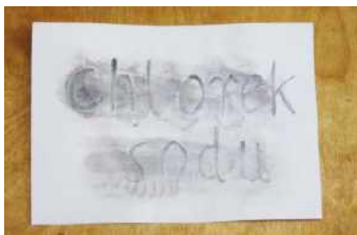
6. Napis sporządzony roztworem chlorku sodu, następnie wywołany roztworem azotanu(V) srebra i wystawiony na działanie światła słonecznego
