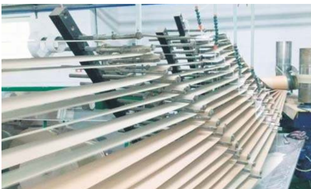
Tuleje tekturowe konstrukcyjne i nawojowe zwijane są spiralnie lub równolegle.
