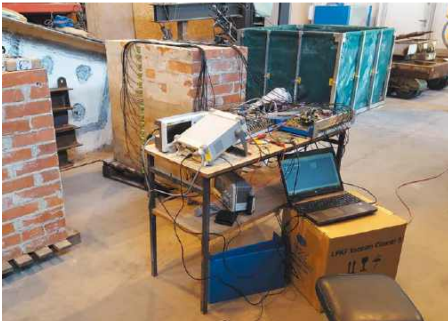
FOT. 1 Pierwsze badania wilgotności modelowych murów ceglanych z wykorzystaniem prototypowego tomografu impedancyjnego, stanowisko badawcze w laboratorium Wydziału Budownictwa Lądowego i Wodnego Politechniki Wrocławskiej; fot.: AH
