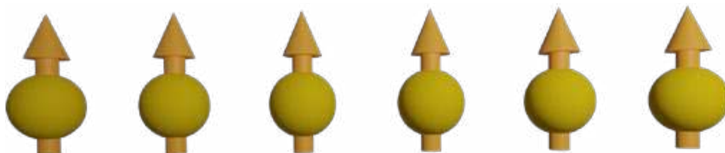
Rys. 1. Schematyczne i uproszczone przedstawienie ferromagnetyka . Atomy (symbolizowane przez kule) wykazują moment magnetyczny (symbolizowany przez strzałki). Ich kierunek i zwrot są uporządkowane w wybranym kierunku (tutaj – w górę) bez zewnętrznego pola.
