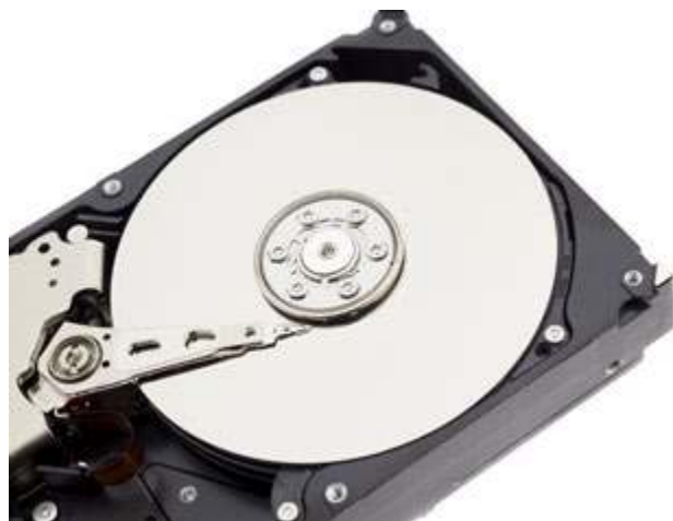
Rys. 3. Magnetyczny dysk twardy; nad dyskiem, który składa się z wielu niewidocznych okiem komórek pamięci, widoczne jest ramię z głowicą, która porusza się by dokonywać odczytu i zapisu.
