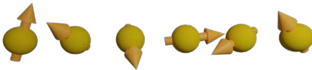
Rys. 5. Schematyczne i uproszczone przedstawienie paramagnetyka . Atomy (symbolizowane przez kule) wykazują moment magnetyczny (symbolizowany przez strzałki), które są ukierunkowane chaotycznie bez zewnętrznego pola magnetycznego.
