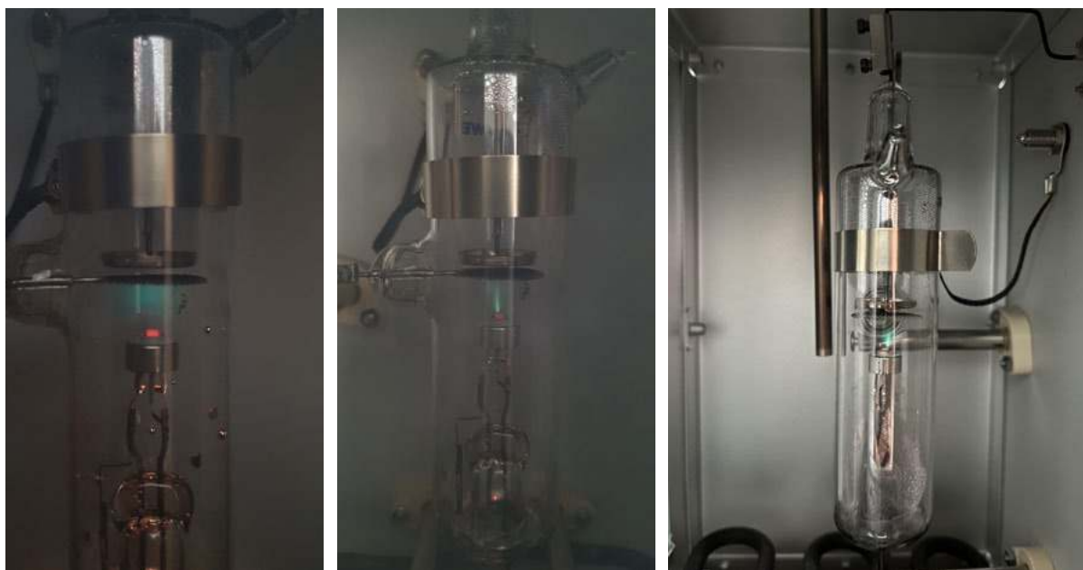
Ryc. 7. Doświadczenie F-H w parach rtęci. Emisja światła z atomów Hg zarejestrowana przy temperaturze T = 163^{\circ}\text{C} (napięcie żarzenia katody U_H = 6\text{V} , ryc. 7a i c) oraz w temperaturze T = 107^{\circ}\text{C} ( U_H = 5\text{V} , ryc. 7b). Ryc. 7a i c przedstawiają przypadek większego ciśnienia par Hg (o czynnik 10 w stosunku do ryc. 7b). W konsekwencji, elektrony na ryc. 7b rozpraszają się (średnio) jednokrotnie, a na rys. 7a i c – wielokrotnie: obserwujemy ich wiązkę (7b) lub rój (swarm, ryc. 7a i c). Ryc. 7c przedstawia moment pojawienia się pierwszego minimum w charakterystyce I-V na ryc. 4a. Czerwony punkcik na dole to rozżarzona katoda. Foto BJ i GK.
