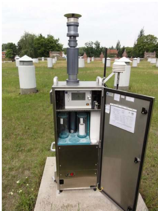
Fot. 1 - Urządzenie do pomiarów stężeń pyłu zawieszonego PM10 i PM2,5, fot - https://powietrze.gios.gov.pl/pjp/content/show/1000919
