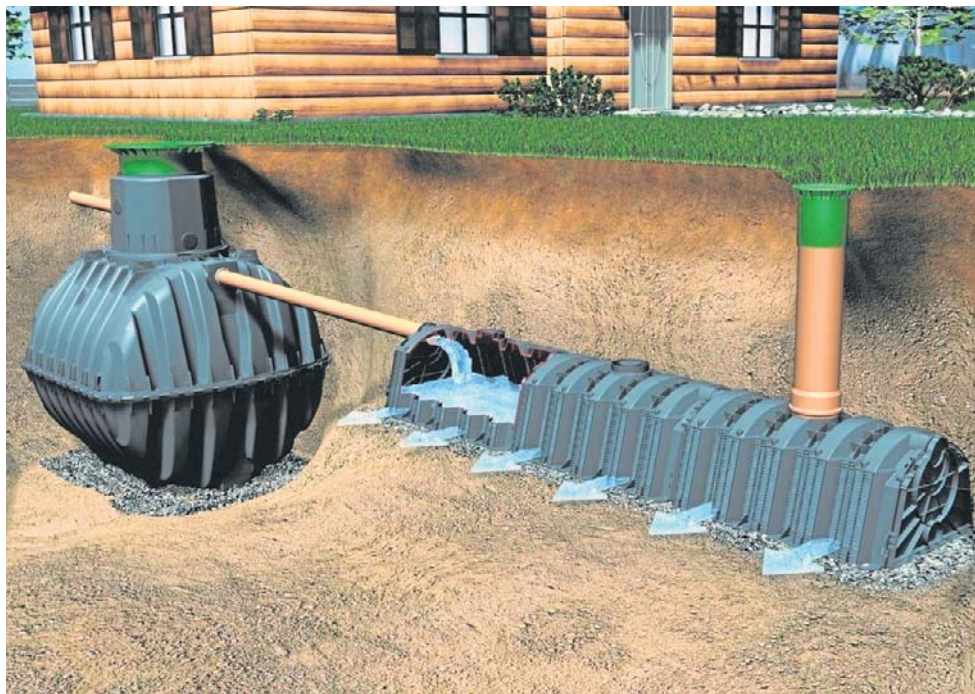
To rozwiązanie skierowane przede wszystkim do mieszkańców domów położonych z dala od istniejącej sieci kanalizacyjnej.
