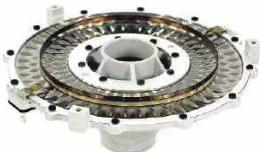
Pierścieniowa membrana średnio-wysokotonowego ma dużą powierzchnię, pofalowaną dla rozproszenia rezonansów, a cewka drgająca ma średnicę aż 12,5 cm
