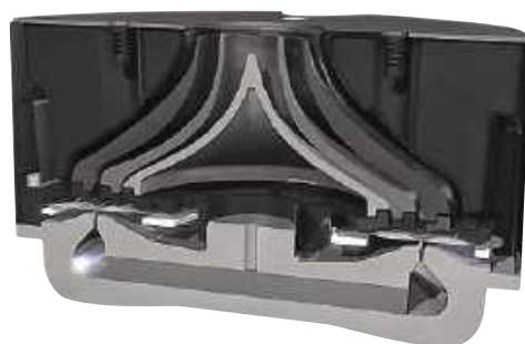
Ciśnienie od pierścieniowej membrany biegnie trzema okrągłymi szczelinami, zbiegającymi się w wylocie o średnicy 5 cm, będącym jednocześnie wlotem samej tuby
