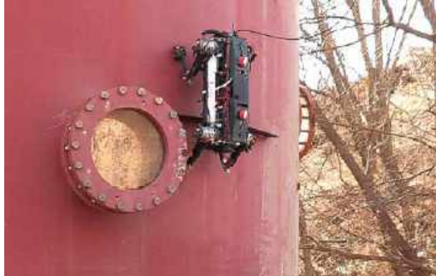
5. Robot Marvel wspiną się po ścianie zbiornika
