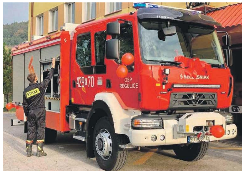
Renault D16 posiada 6-osobową kabinę, napęd na cztery koła i silnik o mocy prawie 300 KM
